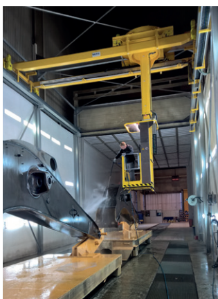
SLF-Strahlraum mit Strahlroboter ReCo-Blaster®, kranbrücken-geführt in Drehvorrichtung
