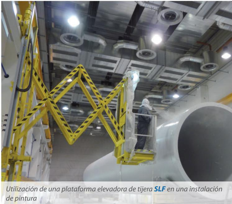
des, diseñamos nuestras plataformas elevadoras de trabajo con una construcción especialmente protegida contra el desgaste y el polvo para su uso en salas de chorreado, así como con un diseño protegido contra las salpicaduras o las explosiones para su uso en zonas potencialmente explosivas, como las cabinas de pintura.
