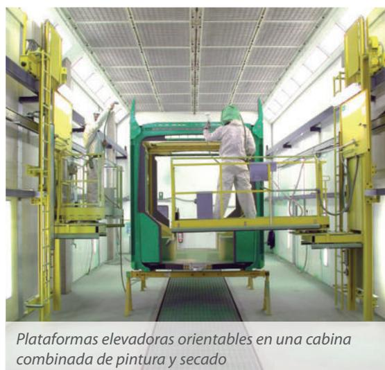
Plataformas elevadoras orientables en una cabina combinada de pintura y secado
