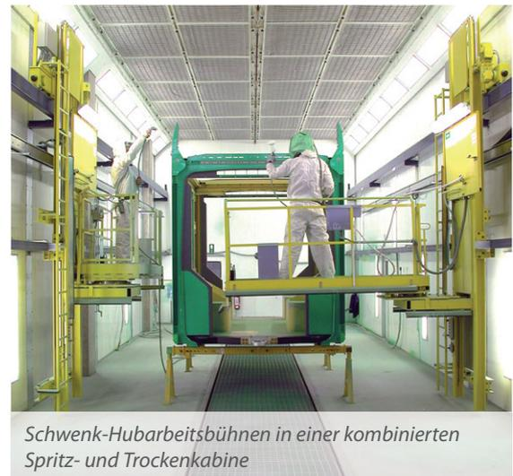
Schwenk-Hubarbeitsbühnen in einer kombinierten Spritz- und Trockenkabine
