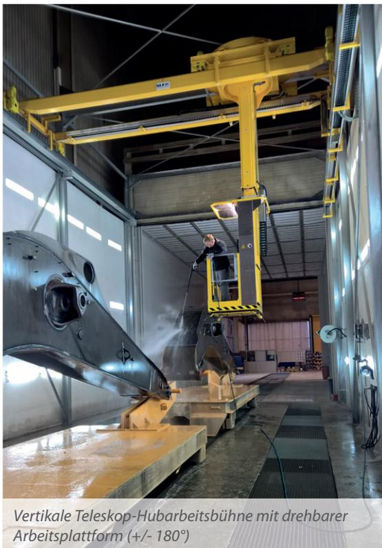
Vertikale Teleskop-Hubarbeitsbühne mit drehbarer Arbeitsplattform (+/- 180°)
