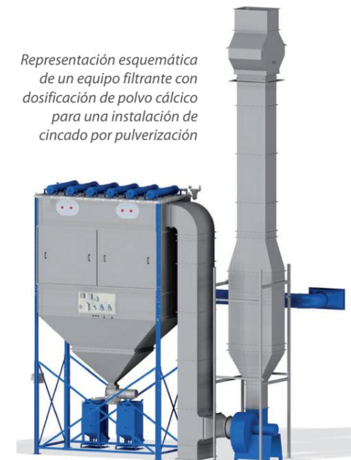
ficación de polvo cálcico así como una instalación de extinción de incendios CO<sub>2</sub>. El equipamiento para el cincado por pulverización
