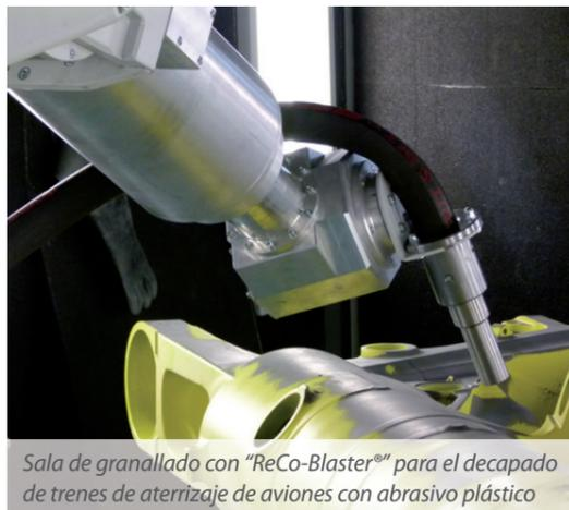
Sala de granallado con “ReCo-Blaster®” para el decapado de trenes de aterrizaje de aviones con abrasivo plástico
