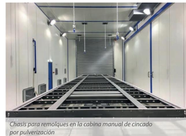
Chasis para remolques en la cabina manual de cincado por pulverización
