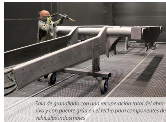
Sala de granallado con una recuperación total del abrasivo y con puente grúa en el techo para componentes de vehículos industriales
