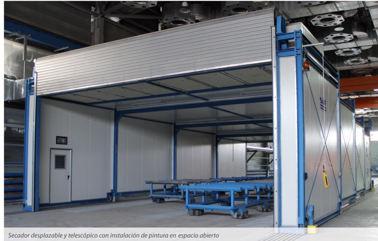
Secador desplazable y telescópico con instalación de pintura en espacio abierto
