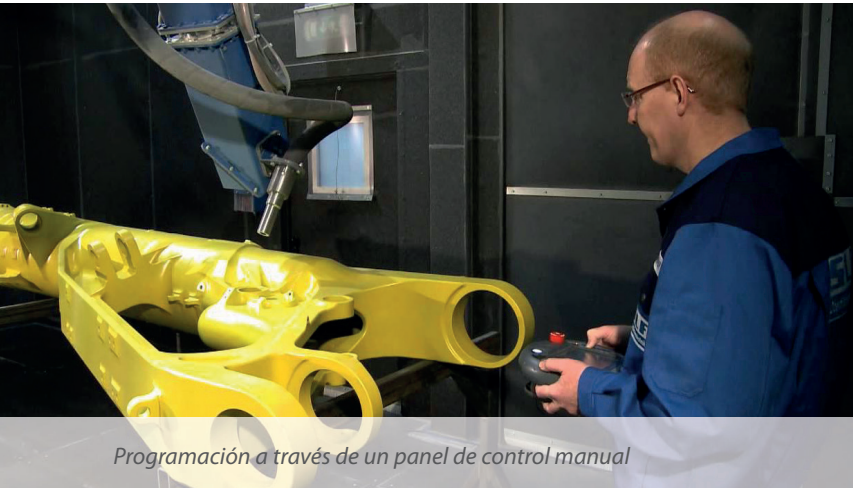
Robot de granallado para segmentos y componentes de torres eólicas
