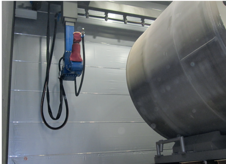
Sala de granallado con „ReCo-Blaster®“ para segmentos y componentes de torres eólicas
