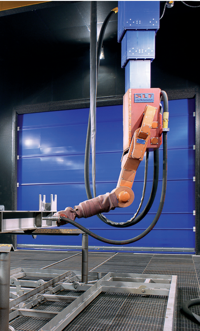
Sala de granallado con „ReCo-Blaster®“ para segmentos y componentes de torres eólicas
