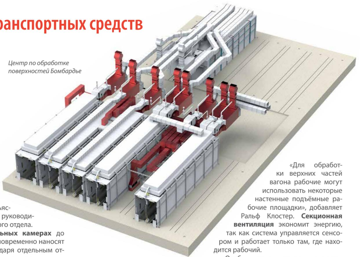
«Для обработки верхних частей вагона рабочие могут использовать некоторые настенные подъёмные рабочие площадки», добавляет Ральф Клостер. **Секционная вентиляция** экономит энергию, так как система управляется сенсором и работает только там, где находится рабочий.
