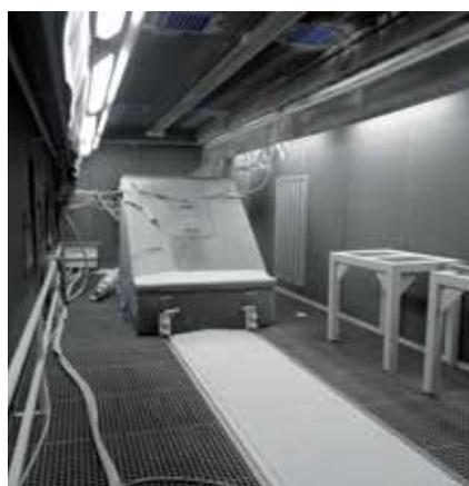
Дробеструйная установка для валков с автоматическим поворотным устройством и колебанием сопел
