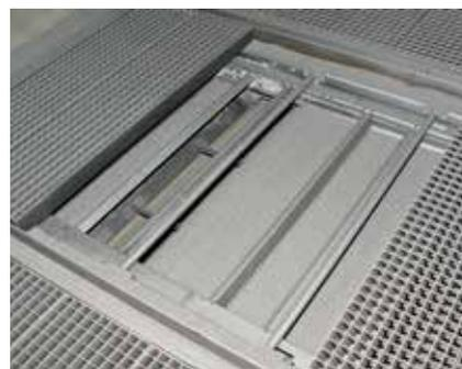
Образец плоского транспортирующего пола
