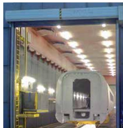
*Дробеструйная камера для дробеочистки рельсовых транспортных средств с поворотными подъёмными рабочими площадками*
