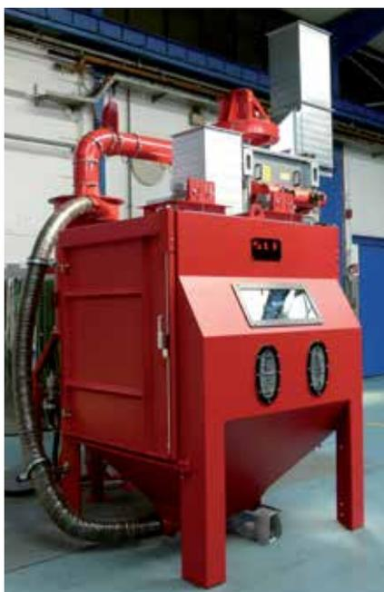
Кабина для ручной обработки с пневматической подачей дроби
