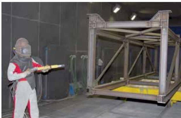
Дробеструйная камера с рельсовой тележкой
