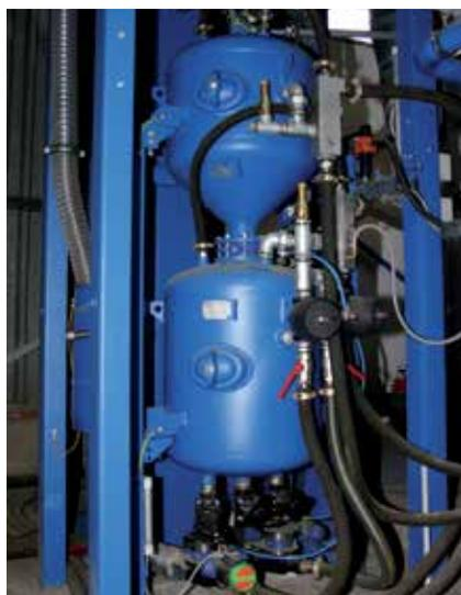
Образец двухкамерного абразивоструйного устройства
