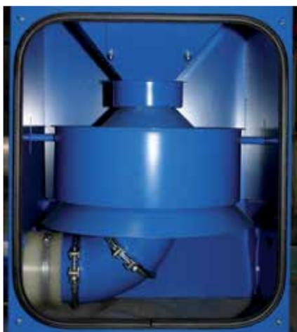
Схематическое представление и образец системы регенерации абразива с воздушной сепарацией
