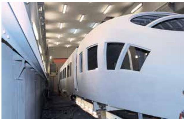
Дробеструйная камера для рельсовых транспортных средств с подъемными рабочими площадками
