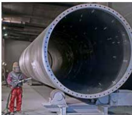
Дробеструйная камера с поворотным устройством для обрабатываемых деталей – частей башней ветросиловых установок
