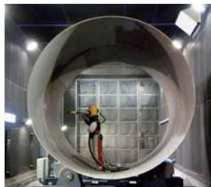
Дробеструйная камера для компонентов ветросиловых установок
