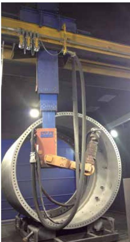
Автоматическая дробеструйная обработка башней ветросиловых установок
