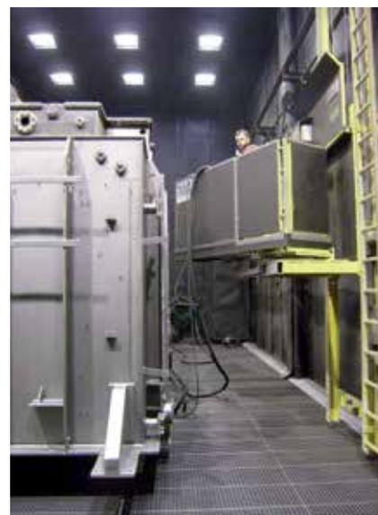
*Дробеструйная камера с поворотными подъёмными рабочими площадками для дробеструйной обработки трансформаторов*
