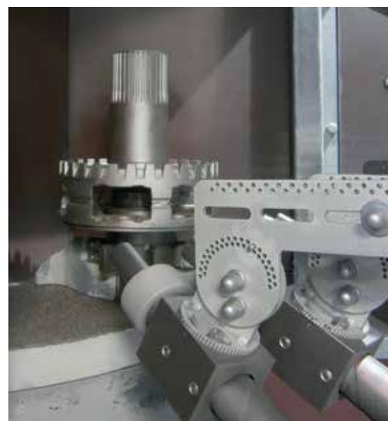
Установка для упрочняющей обработки (Shotpeening) для планетарных передач с автоматическим перемещением заготовок
