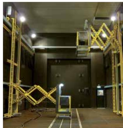
*Дробеструйная камера с телескопическими подъёмными рабочими площадками*
