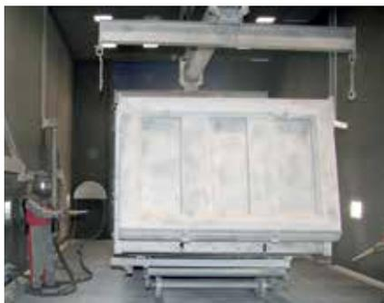
Дробеструйная камера с подъемным устройством для обрабатываемых деталей – полуприцепов
