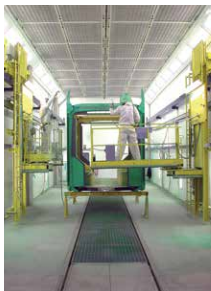
Поворотная подъёмная рабочая площадка в комбинированной окрасочно-сушильной камере
