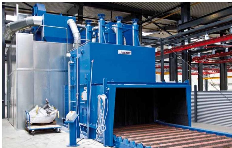
Дробемётная установка с роликовым транспортером фирмы „AGTOS“
