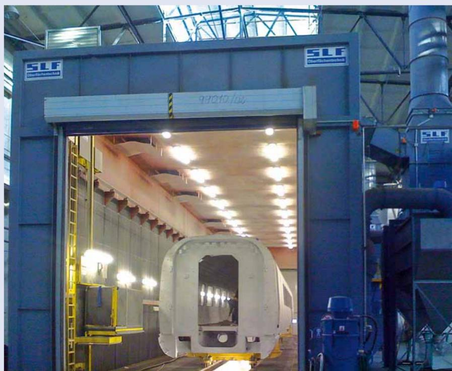
Дробеструйная камера для рельсовых транспортных средств
