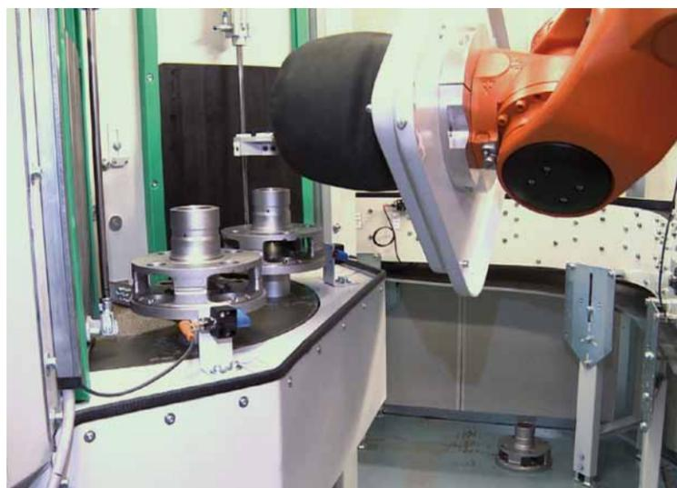
Дробеструйная тактовая автоматическая установка с поворотным столом и автоматической загрузкой и выгрузкой
