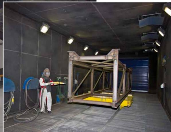
Дробеструйная камера с полной колосниковой решёткой и режимом рециркуляции для крупногабаритных деталей
