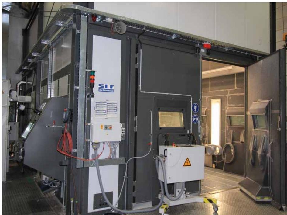
Внешний вид дробеструйной камеры с дробеструйным роботом „ReCo-Blaster“
