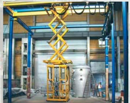
*Plataforma telescópica de 3 ejes para procesar componentes grandes.*
