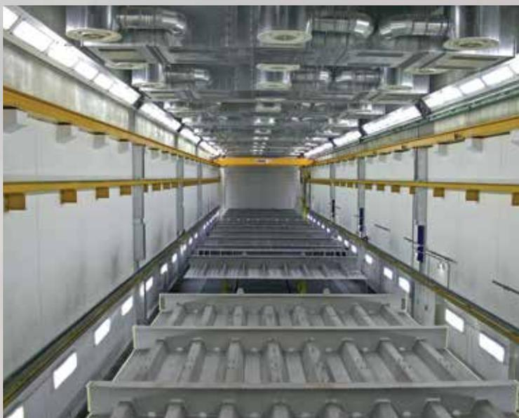
*Cabina combinada de pintura y secado con ventilación seccional mediante boquillas de largo alcance para elementos de puentes.*
