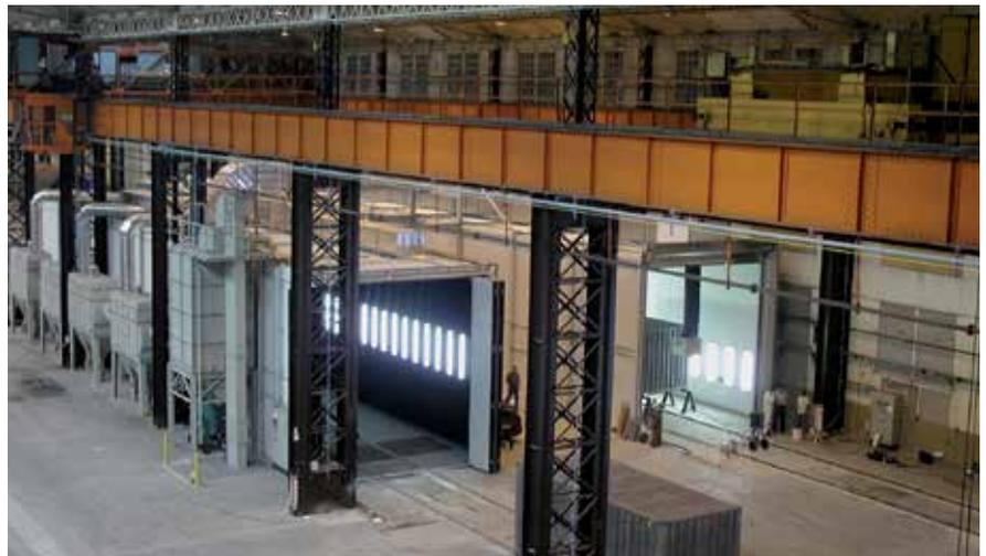
*Sistema de granallado con diseño de absorción de ruidos, diseñado para el tratamiento de torres eólicas. El granallado de piezas muy altas es posible gracias a las paredes con desplazamiento montadas en la plataforma de trabajo.*
