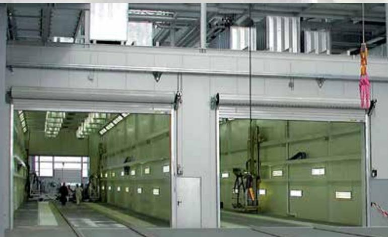
*Combinación de cabinas de pintura y de secado con ventilación seccional mediante boquillas de largo alcance para palas de rotor.*
