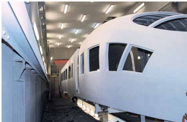
Freistrahlnraum für Schienenfahrzeuge mit Hubarbeitsbühnen
