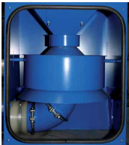
Schematische Darstellung sowie Beispielansicht der Strahlmittelwiederaufbereitung mit Windsichtung
