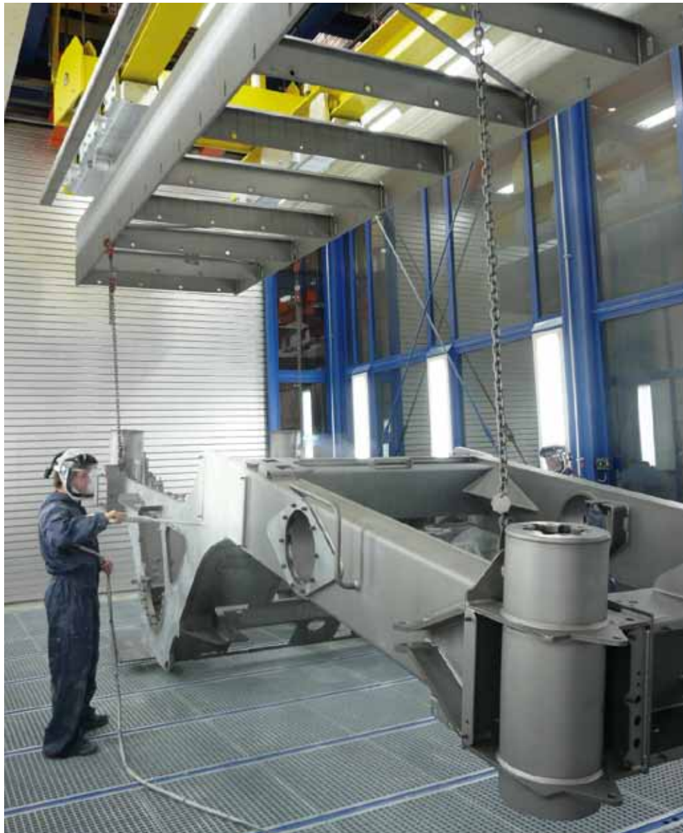
Pulverbeschichtung von Großbauteilen (Wirtgen GmbH)
