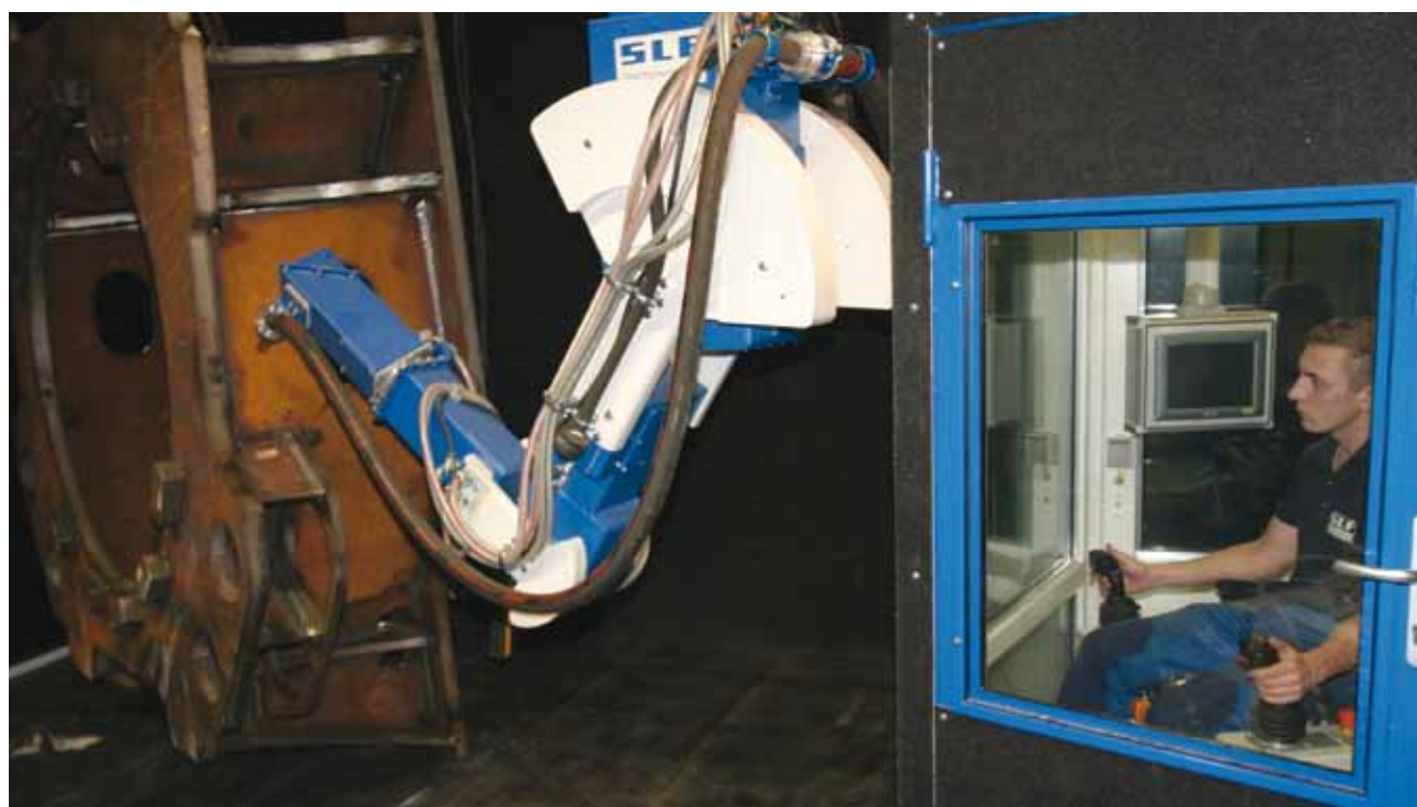
Neu entwickelter SLF Strahlroboter „ReCo-Blaster“
