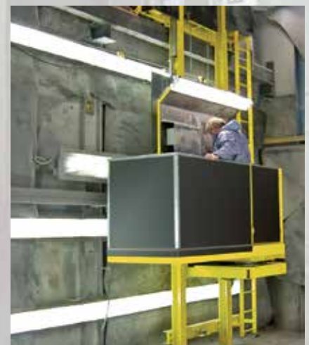
Перемещаемая, поворотная рабочая площадка в дробеструйной камере.
