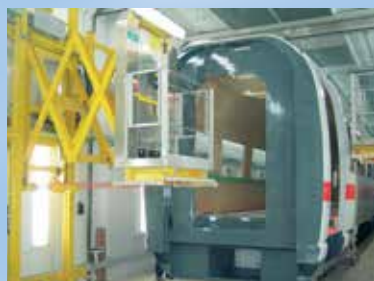
Окрасочный цех с перемещающейся вдоль стены телескопической рабочей площадкой.
