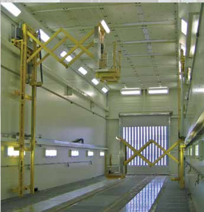
Перемещаемые вдоль стены телескопические подъемные рабочие площадки в окрасочной камере.
