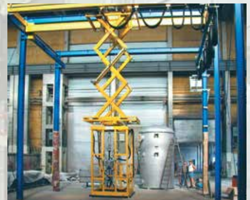
3-осевая телескопическая площадка для обработки больших компонентов.
