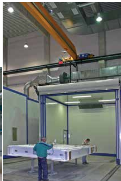
Открытая окрасочная площадка с телескопической сушильной камерой.
