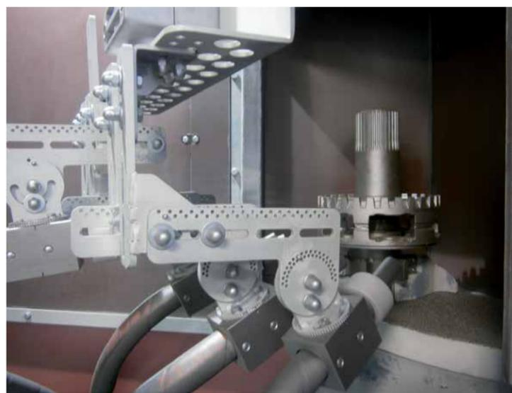
Заготовки обрабатываются с помощью пяти дробеструйных сопел при точном соблюдении нескольких дробеструйных параметров.
