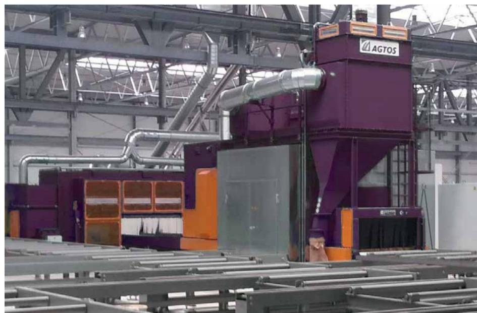
Дробеструйная установка с роликовым транспортером AGTOS с последовательно подключенной окрасочной установкой и сушильной камерой.
