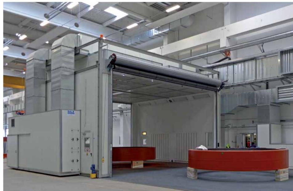
После нанесения покрытия обрабатываемые детали остаются на их месте и камера перемещается в новую рабочую позицию.
