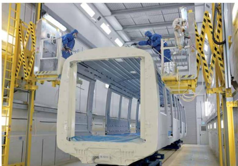
С наших подъёмных рабочих площадок возможно и безопасное нанесение покрытия на кузова.
