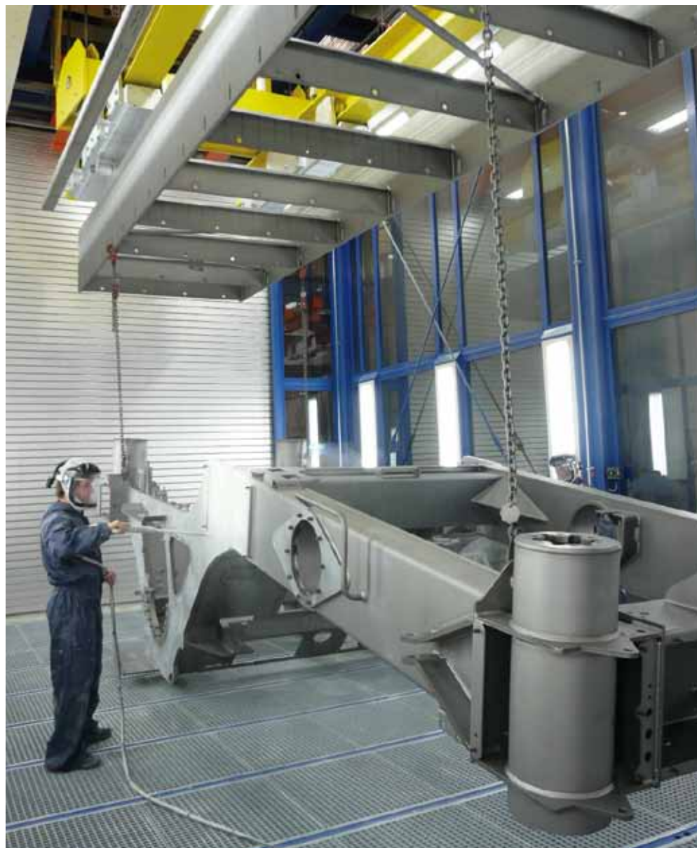
Порошковое покрытие крупногабаритных изделий (Wirtgen GmbH)
