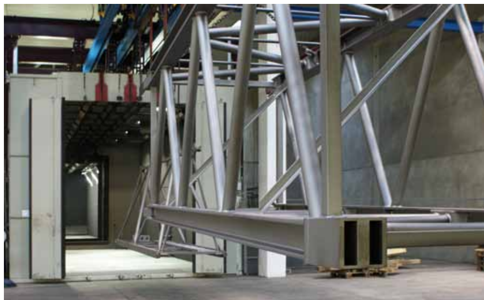
AGTOS-Подвесная монорельсовая дробеструйная установка (3,5 x 2,5 x 32 м)
