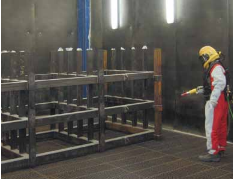
Дробеструйное помещение открытого типа с возможностью обратной подачи дробы
