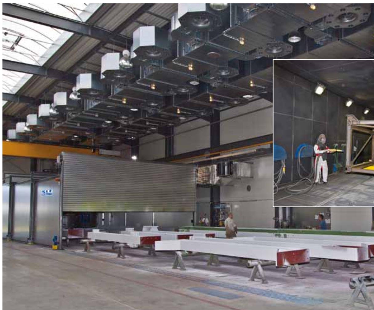
Effektivste Nutzung von Freiflächenlackieranlagen: Die Kombination mit einem verfahrbaren Teleskoprockner
