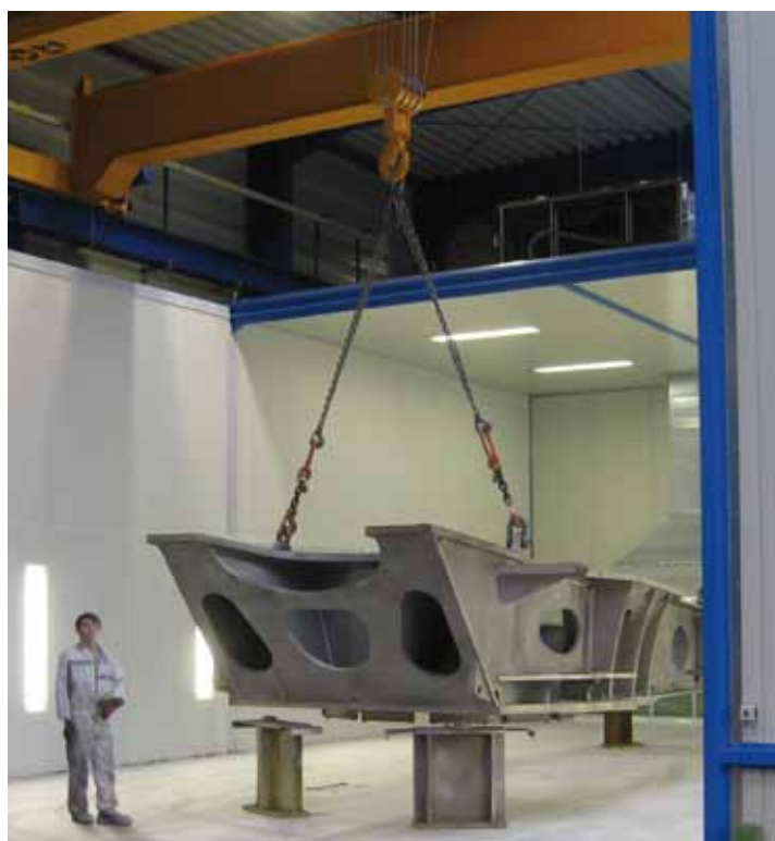
Beschickung der Twin-Cabin mit dem Hallenkran
