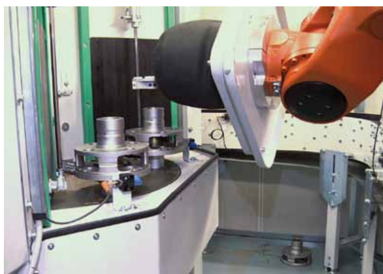
Druckstrahl-Taktdrehtischanlage mit automatischer Be- und Entladung
