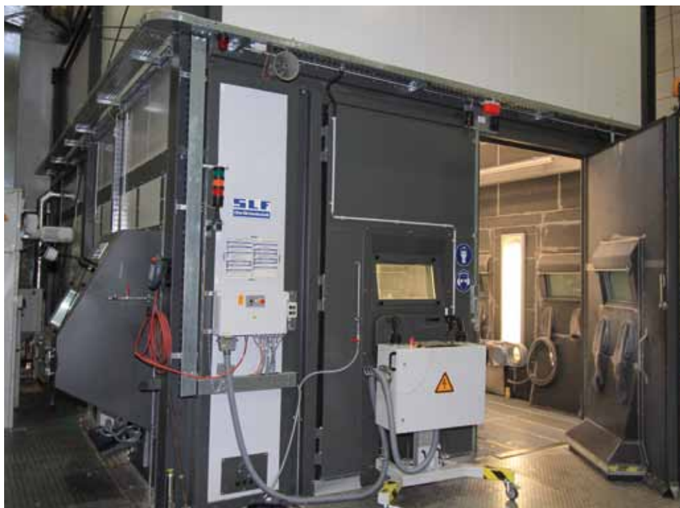
Außendarstellung eines Freistrahtraums mit Strahlroboter ReCo-Blaster®
