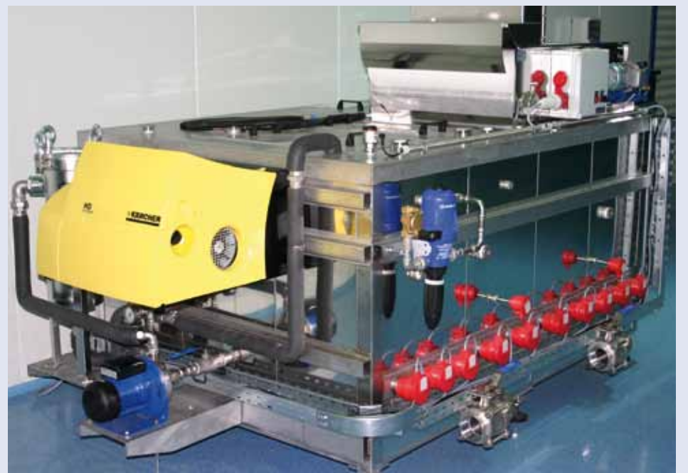
Hochwertige Materialien, wartungsfreundliche Anlagenkomponenten und ideal aufeinander abgestimmte Modulbauweise zeichnen die SLF-Wasseraufbereitung aus.
