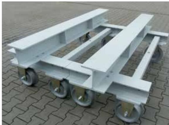
Состоящая из двух частей рельсовая транспортная тележка для ручного перемещения обрабатываемой детали
