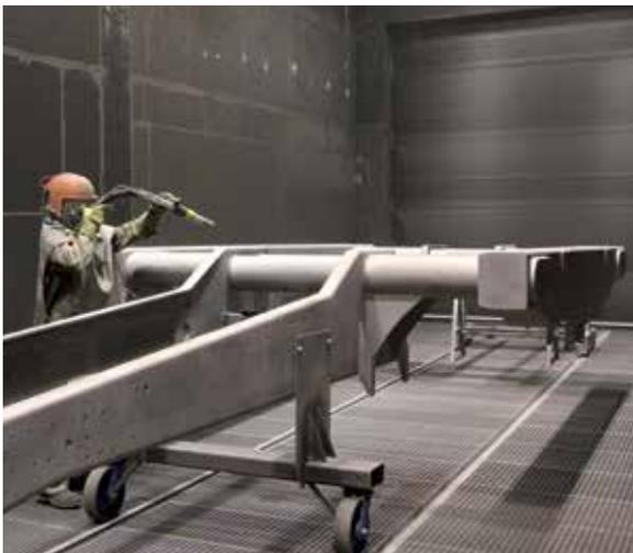
Дробеструйная камера с возвратом использованной дроби из всей площади камеры и мостовым краном для компонентов грузовых автомобилей
