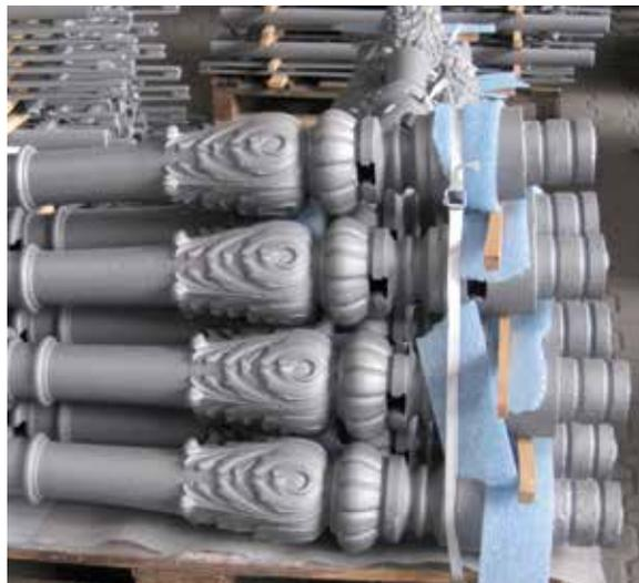
*Обработанные дробью и подготовленные к транспортировке изделия*
