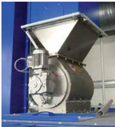
Двойной магнитный валковый сепаратор для отделения ферритового и неферритового абразивного материала или остатков материала
