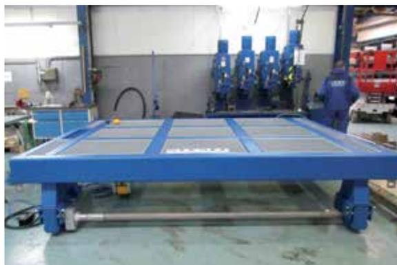
Рельсовая транспортная тележка с электроприводом с подъемным столом
