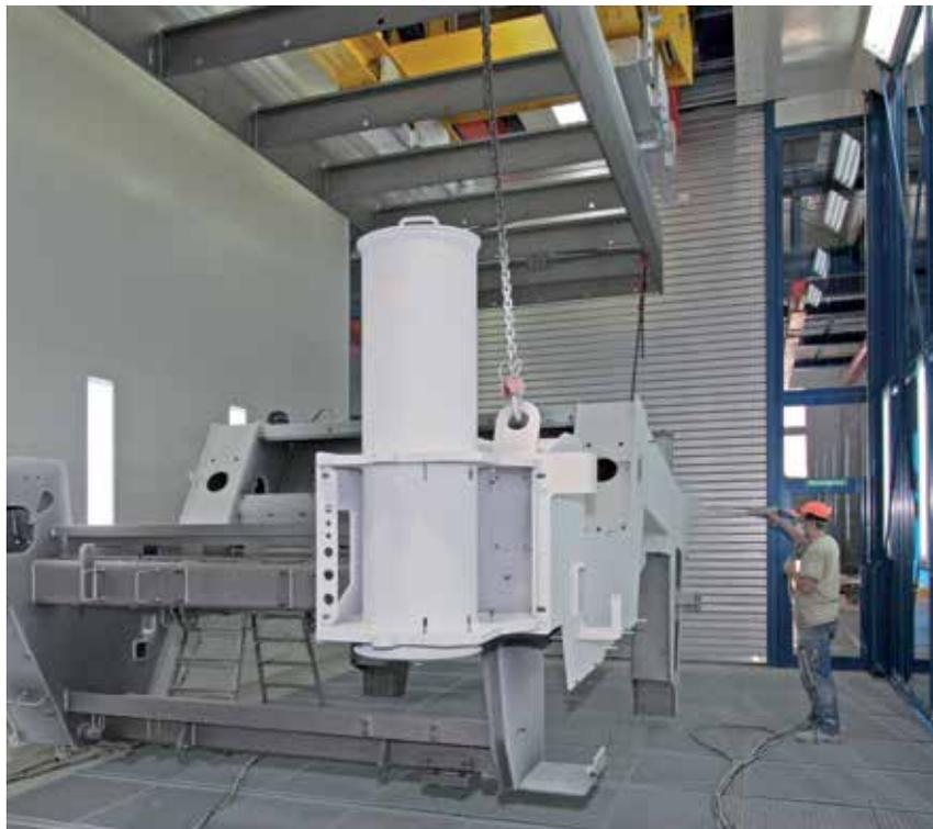
*Крупногабаритная камера для нанесения порошковых покрытий на компоненты грузовых автомобилей*
