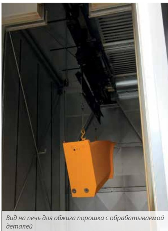
Вид на печь для обжига порошка с обрабатываемой деталью
