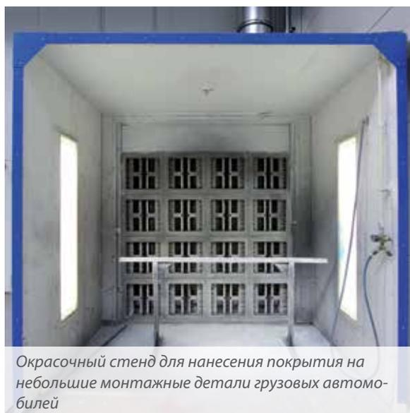
Окрасочный стенд для нанесения покрытия на небольшие монтажные детали грузовых автомобилей
