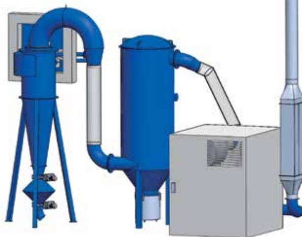
Схематическое представление устройства отсоса дробы
