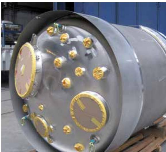
*Обработанный стеклянной дробью резервуар из нержавеющей стали до последующего нанесения покрытия*
