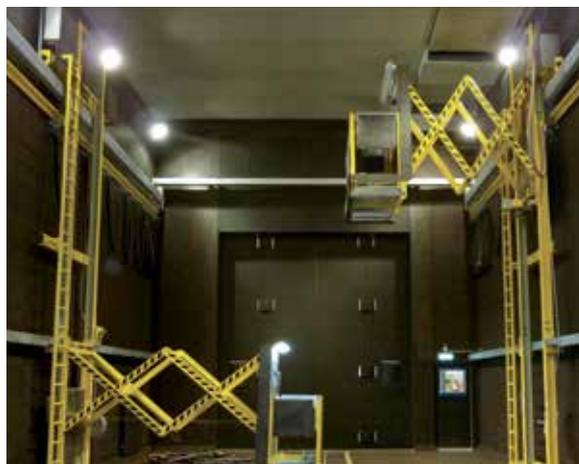
Перемещаемые вдоль стены телескопические подъёмные рабочие площадки в дробеструйной камере
