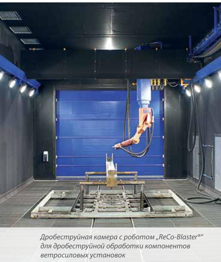
*Дробеструйная камера с роботом „ReCo-Blaster®“ для дробеструйной обработки компонентов ветросиловых установок*
