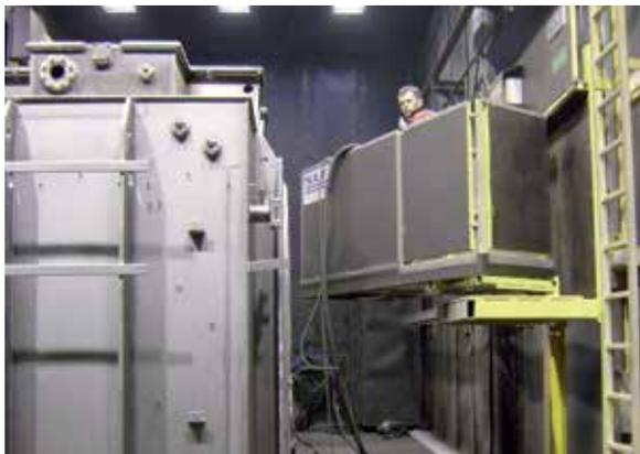
Поворотная подъёмная рабочая площадка в дробеструйной камере
