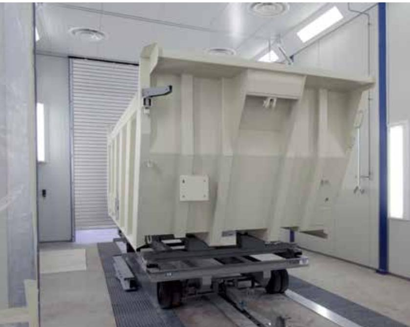
Транспортная тележка для обрабатываемых деталей, связанная с расположенным в полу окрасочной камеры цепным конвейером.
