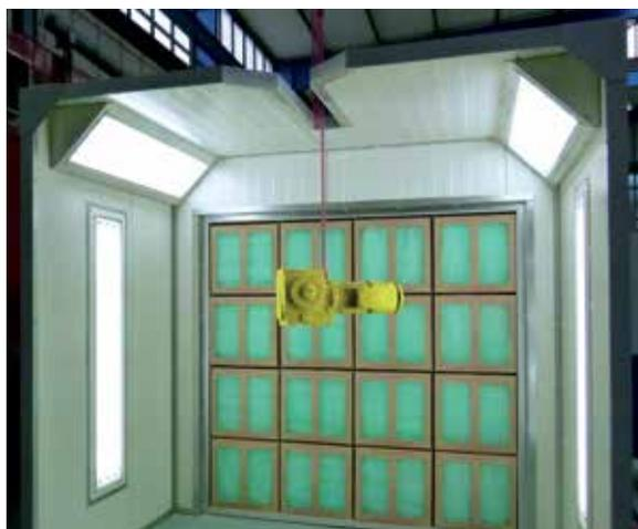
Окрасочный стенд с фильтрами типа „Edrizzi“ и отверстием в потолке для загрузки с помощью крана
