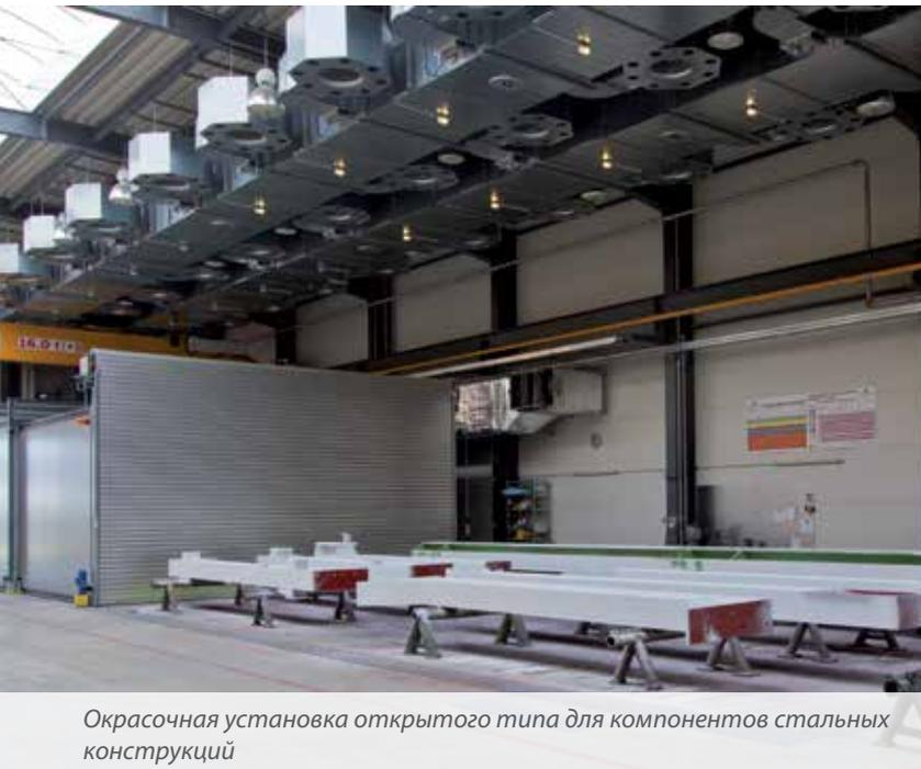
Окрасочная установка открытого типа для компонентов стальных конструкций
