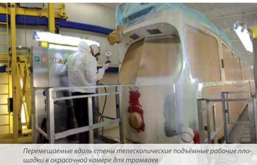
Перемещаемые вдоль стены телескопические подъёмные рабочие площадки в окрасочной камере для трамваев
