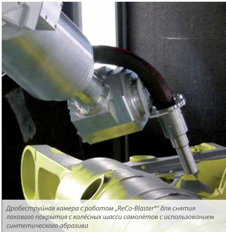
*Дробеструйная камера с роботом „ReCo-Blaster®“ для снятия лакового покрытия с колёсных шасси самолётов с использованием синтетического абразива*
