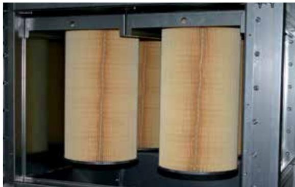
Фильтрующие патроны в нашей фильтровальной установке можно заменять без особых усилий и без входа в помещение неочищенного газа.
