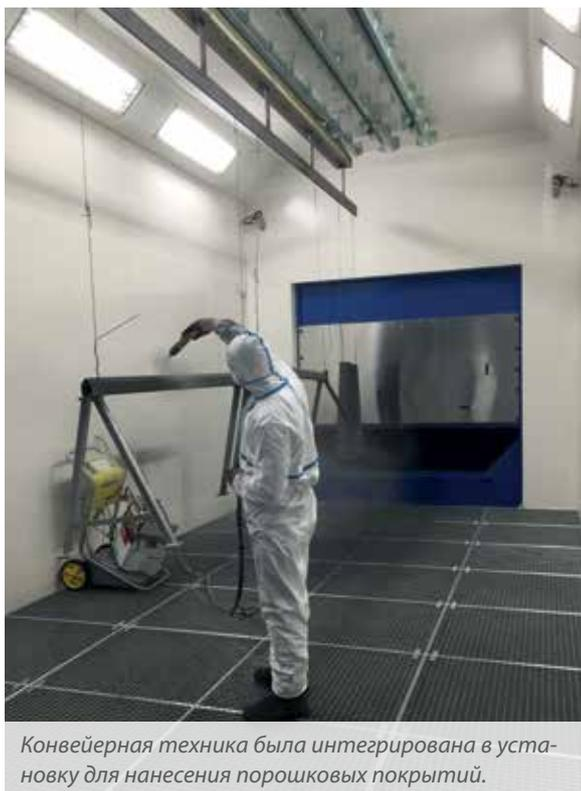
*Конвейерная техника была интегрирована в установку для нанесения порошковых покрытий.*
