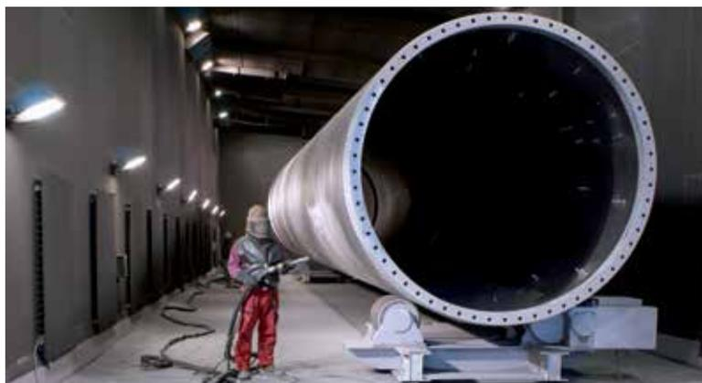
Дробеструйная камера для частей и компонентов башен ветросиловых установок
