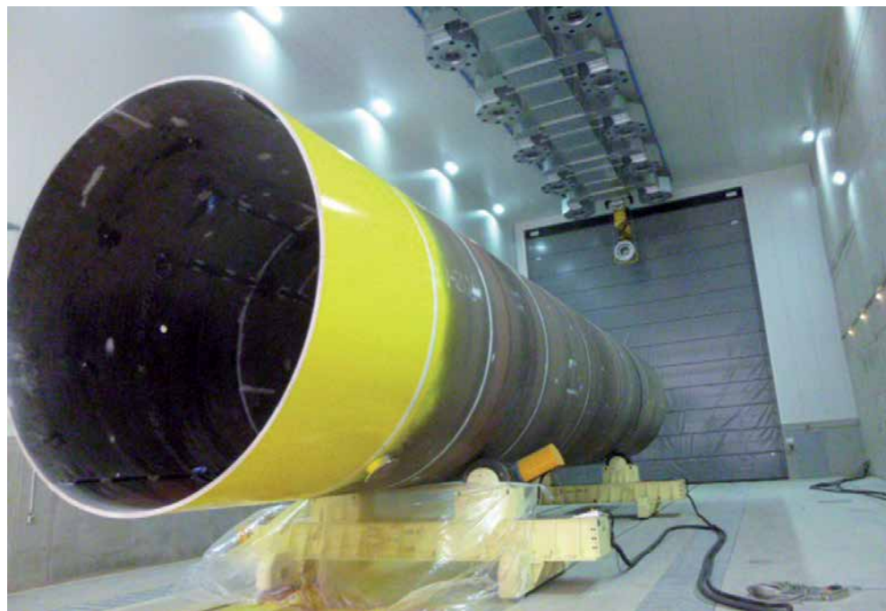
Ein Monopile für eine Offshore-Windkraftanlage wird in der Lackierkabine mit Weitwurfdüsen beschichtet.
