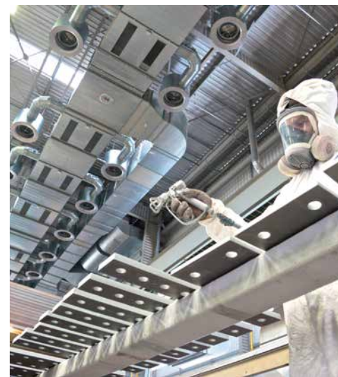
Die Weitwurfdüsen machen eine Einhausung der Lackierfläche überflüssig.
