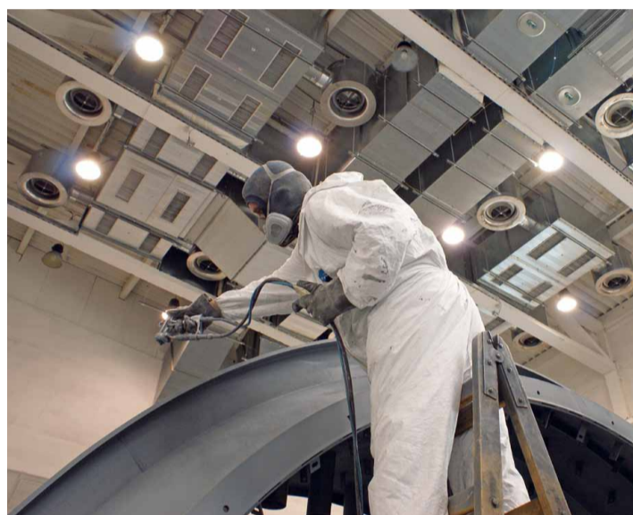
Превосходная окраска крупногабаритных компонентов на окрасочной площадке открытого типа.
