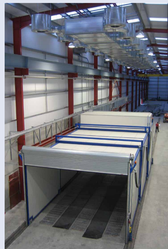
Телескопическая сушильная камера на окрасочной площадке открытого типа.
