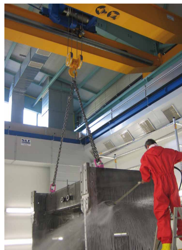
Очистная установка высокого давления с отверстиями для крана на потолке.
