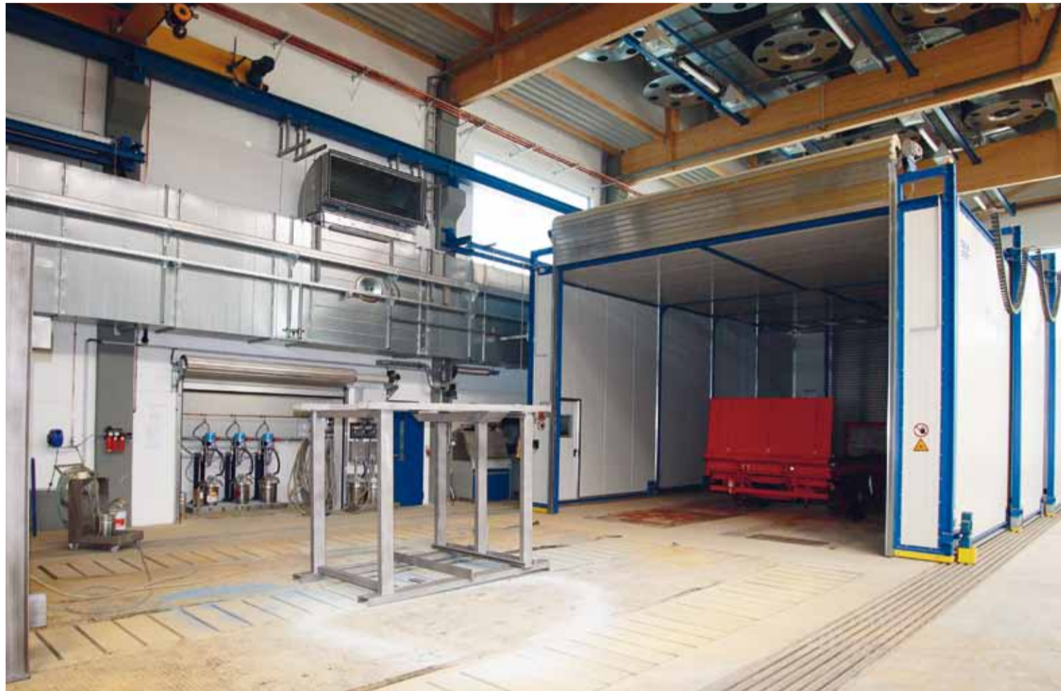
Freiflächenlackierplatz mit verfahrbarem Teleskoprockner.
