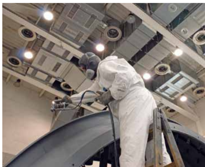
Perfekte Lackierung von Großkomponenten auf der Freiflächenlackieranlage.
