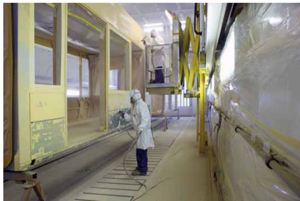
Lackierarbeiten an Combino Bern im Werk Simmering von Siemens Transportation Systems in Wien.
