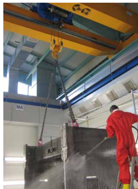
Hochdruckreinigungskabine mit Kranöffnung im Deckenbereich.
