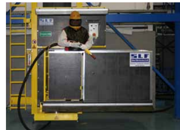
Seitenwandgeführte Hubarbeitsbühne für Freistrahlräume.
