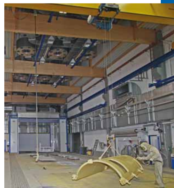
Freiflächenlackierplatz. Im Hintergrund: Verfahrbarer Teleskoprockner in Parkposition.
