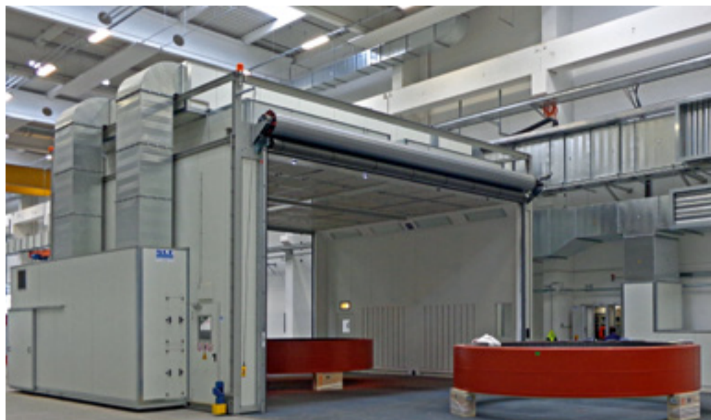
Die beschichteten Werkstücke verbleiben nach der Applikation an ihrem Platz und die Kabine verfährt in eine neue Bearbeitungsposition. Quelle: SLF
