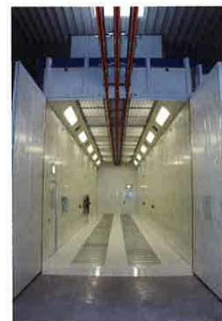
Kombinierte Spritz- und Trockenkabine © SLF Oberflächentechnik GmbH
