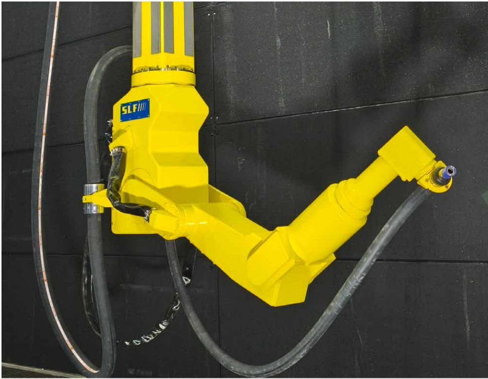
Strahlroboter ReCo-Blaster® im Strahlraum bei MEKON in Rastdorf
