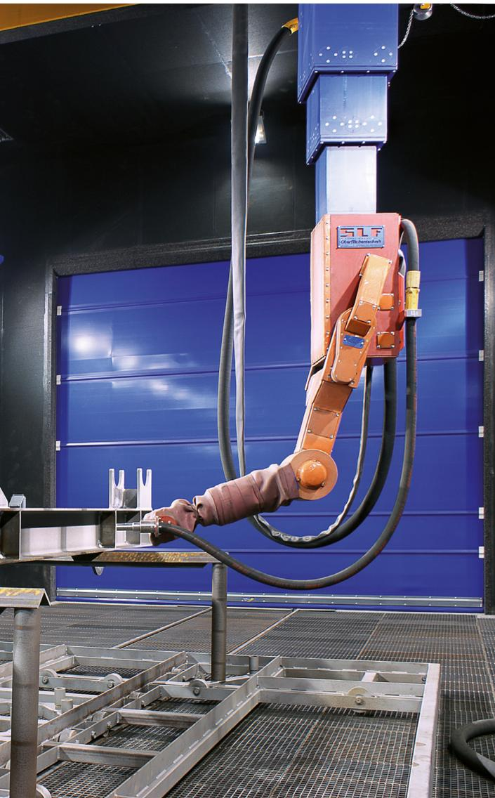
Zusätzlich zur Programmierung des Fahrwegs des Roboters kann auch zu jedem einzelnen Teachpunkt individuell der Strahldruck, der Strahlabstand, die Strahlgeschwindigkeit sowie die Bearbeitungsform festgelegt werden.
