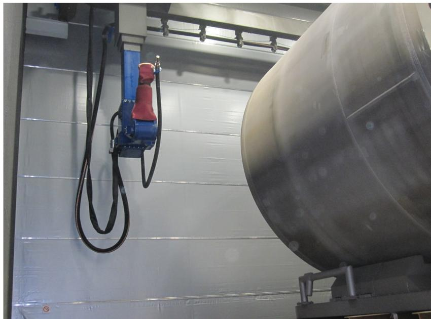
Strahlraum mit „ReCo-Blaster“ für das Strahlen von Windkraftanlagenkomponenten
