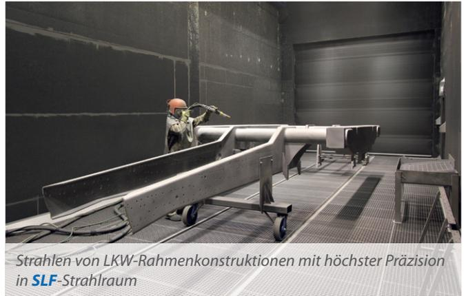
Strahlen von LKW-Rahmenkonstruktionen mit höchster Präzision in SLF-Strahlraum
