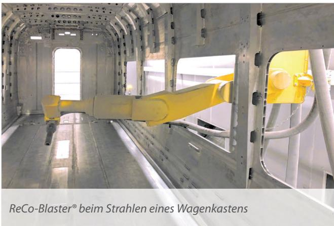
ReCo-Blaster® beim Strahlen eines Wagenkastens
