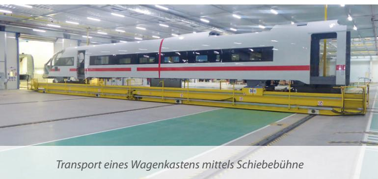
Transport eines Wagenkastens mittels Schiebebühne
