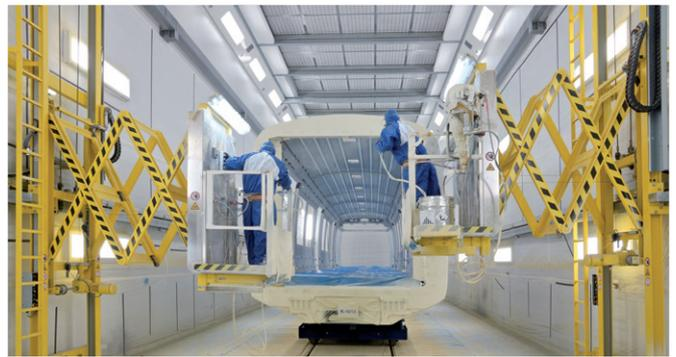
Manuelle Beschichtung von Wagenkästen in einer SLF-Lackierkabine mittels Einsatz von SLF-Scherenhubarbeitsbühnen
