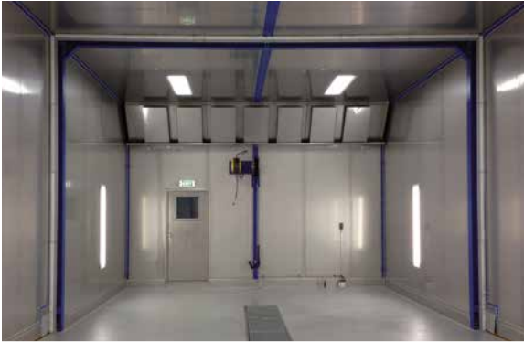
Teleskopierbare Waschkabine in Edelstahlausführung
