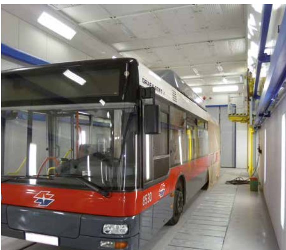
Kombinierte Spritz- und Trockenkabine mit Hubarbeitsbühnen
