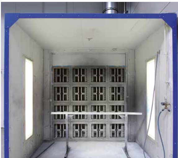
Spritzstand für die Beschichtung kleiner Anbauteile von Nutzfahrzeugen
