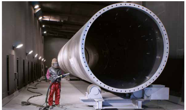
Strahlraum für Segmente und Komponenten von Windkrafttürmen
