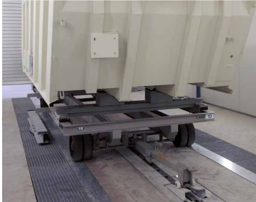
Werkstücktransportwagen mit Verbindung zum Kettenförderer im Boden der Lackierkabine
