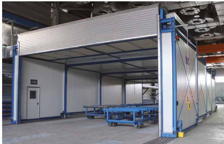
Verfahr- und teleskopierbarer Trockner mit Freiflächenlackieranlage
