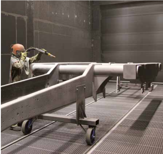
Strahlraum mit vollflächiger Strahlmittelrückförderung und Decken Kran für Komponenten von Nutzfahrzeugen
