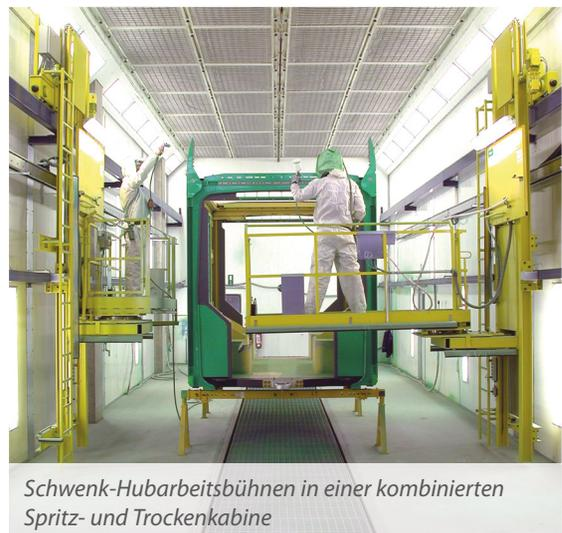
Schwenk-Hubarbeitsbühnen in einer kombinierten Spritz- und Trockenkabine
