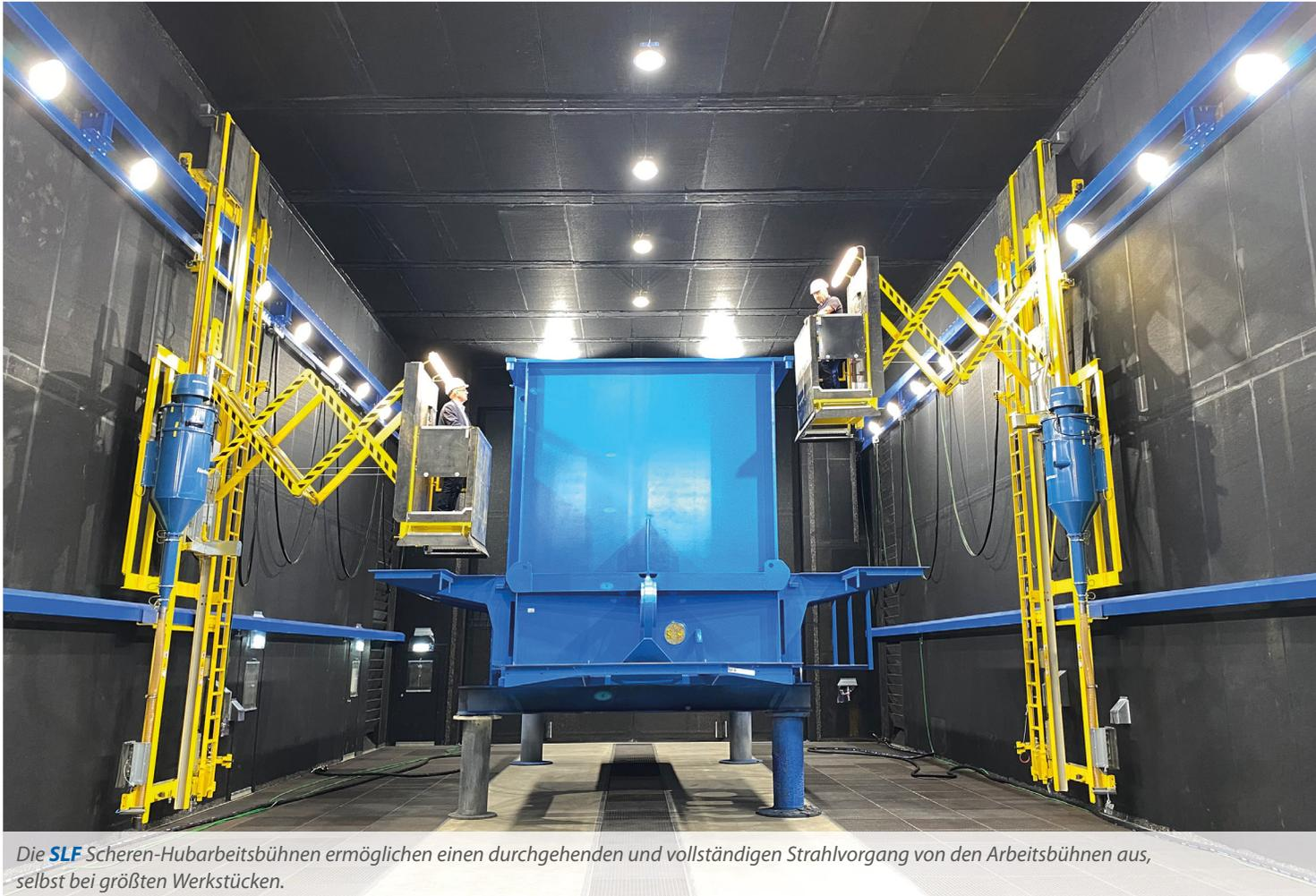
Die **SLF** Scheren-Hubarbeitsbühnen ermöglichen einen durchgehenden und vollständigen Strahlvorgang von den Arbeitsbühnen aus, selbst bei größten Werkstücken.
