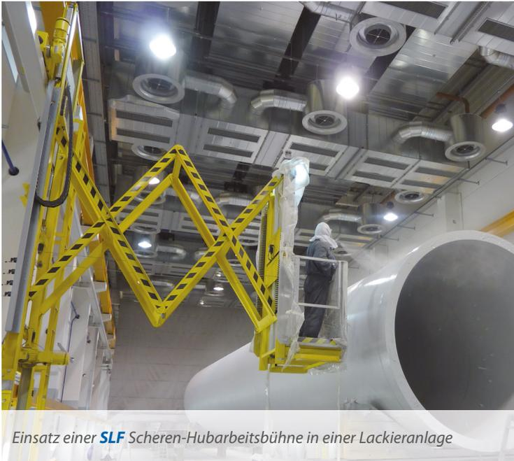
Einsatz einer **SLF** Scheren-Hubarbeitsbühne in einer Lackieranlage
