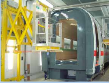
Yan duvara monte edilmiş makaslı-platfömlü donatılmış boyama-holü.
