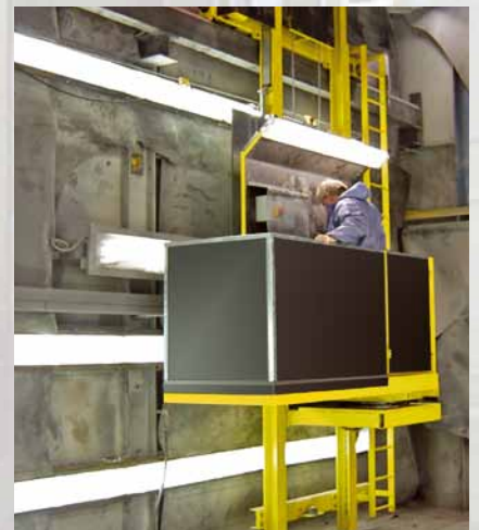
Kumlama kabininde, hareketli ve dönebilen bir Çalışma-Platformu.
