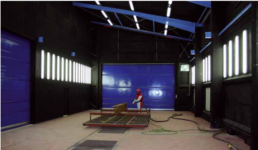
Mayer Tersanesinin gemi parçaları ve blokları için kullanılan, zemini kısmen Pnömatik-Aşındırıcı-Geri-Kazanım-Sistemiyle donatılmış, Kumlama-Mekani/Kabini.
