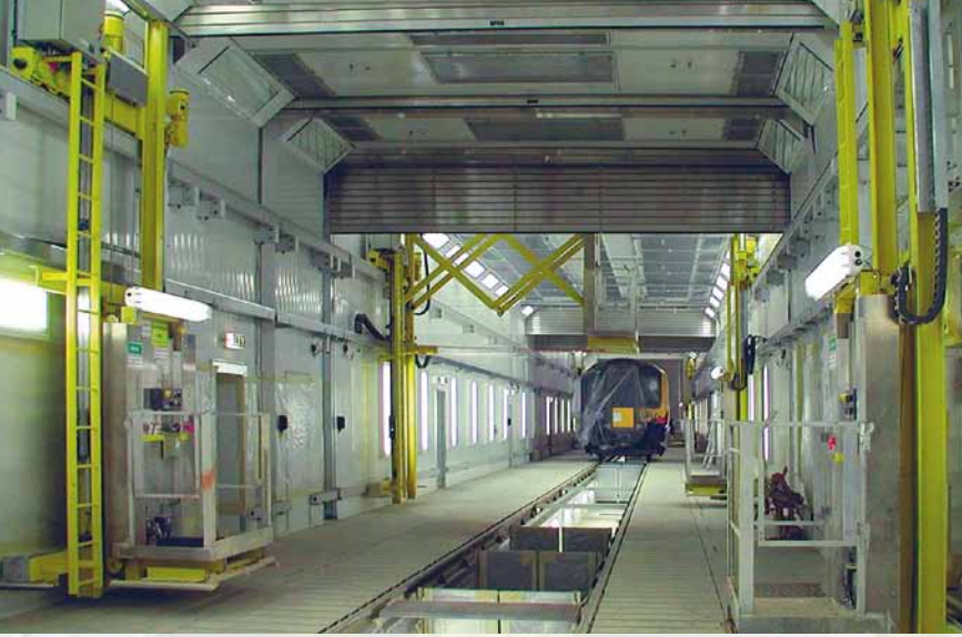
Krefeld şehrindeki, Siemens AG Transportation Şirketi'nde, vagon boyama kabininde, yan duvara bağlı bir platform.
