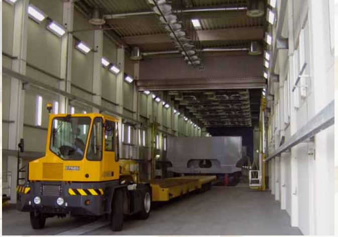
Büyük ve çok büyük parçalar için, SLF-Bölgesel-Havalandırma-Tekniğiyle donatılmış, Tazikli-Suyla-Temizleme- ve Kombine-Yaşboya- ve Kurutma- Holü.
