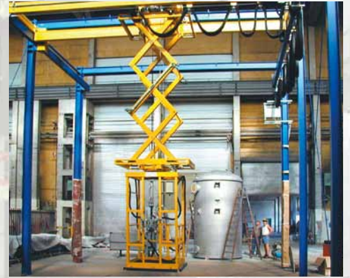
Büyük parçaların işlenebilmesi için, 3-Eksenli-Makaslı-Teleskop-Platform.
