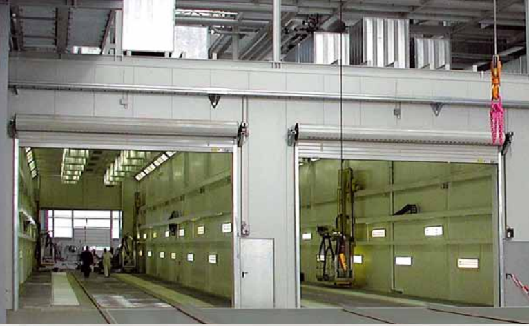
Rüzgar türbini Rotor-Paletleri için, Uzun-Menzilli-Memelerle donatılmış, Bölgesel-Havalandırma-Sistemli, kombine Boyama- ve Kurutma-Kabinini.
