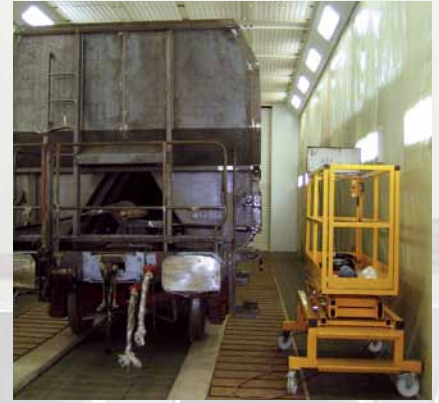
Yük vagonları için kombine Yaşboya-Boyama- ve Kurutma-Kabinini.
