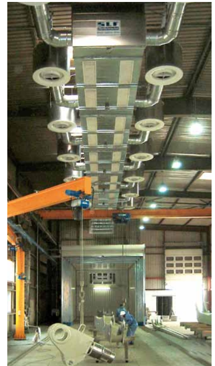
Uzun-Menzilli-Meme-Teknikli, Açık-Mekan-Boyama-Tesisleri ve Teleskoplanabilir-Kurutma-Kabini.
