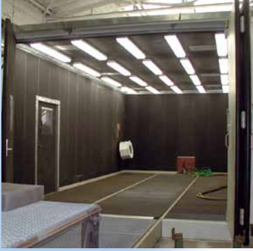
Temel gerektirmeyen, pnömatrik aşındırıcı geri kazanım sistemli kumlama-mekanları ve -kabinleri
