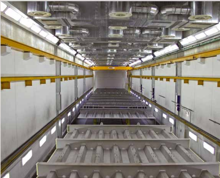
Yapısalçelik köprü segmentleri için, Uzun-Menzilli-Memelerle donatılmış, Bölgesel-Havalandırma-Sistemli, bir kombine Boyama- ve Kurutma-Kabinini.
