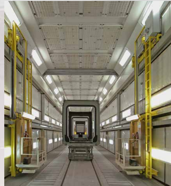
Yolcu vagonları için, Bölgesel-Havalandırma-Sistemli, kombine Boyama- ve Kurutma-Kabinini
