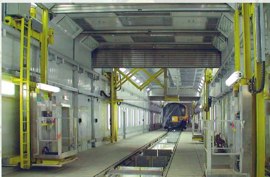
Настенные подъемные платформы с окрасочными кабинами для пассажирских вагонов в корпорации Siemens.
