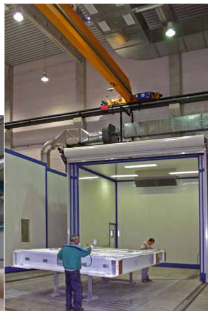
Открытая окрасочная площадка с телескопической сушильной камерой.
