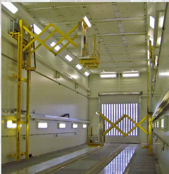
Настенное крепление 3-х осевой платформы в камере окраски.
