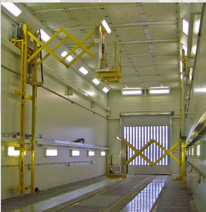
Pomost roboczy nożycowy przesuwany przyściennie w kabinie lakierniczej.
