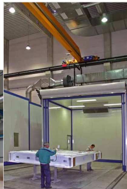
Pomieszczenie do swobodnego strumieniowania z suszarką teleskopową.
