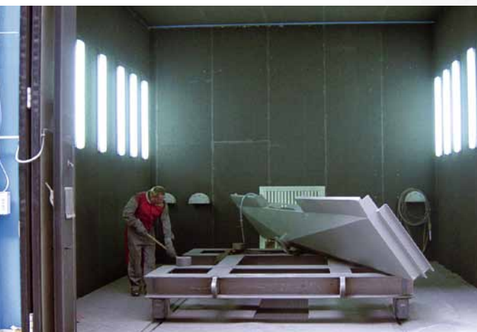
Komora do obróbki strumieniowej dużych komponentów.
