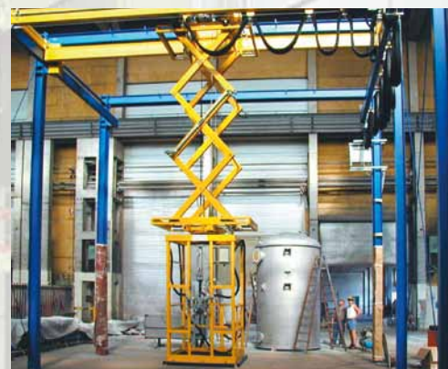
Pomosty teleskopowe trzy-poziomowe do obróbki dużych elementów.
