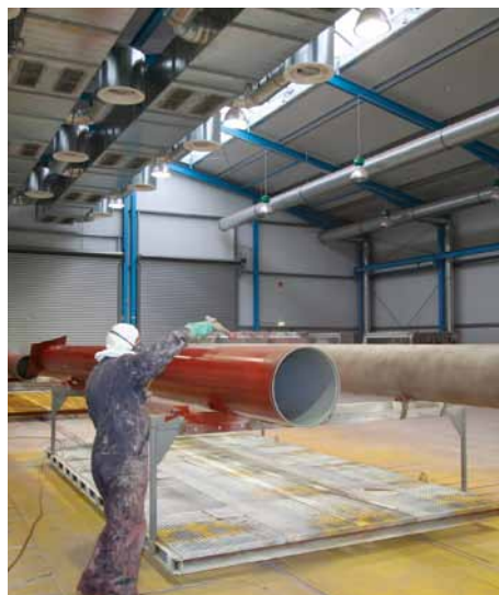
Lakiernia o swobodnym polu malowania do wielofunkcyjnej produkcji.
