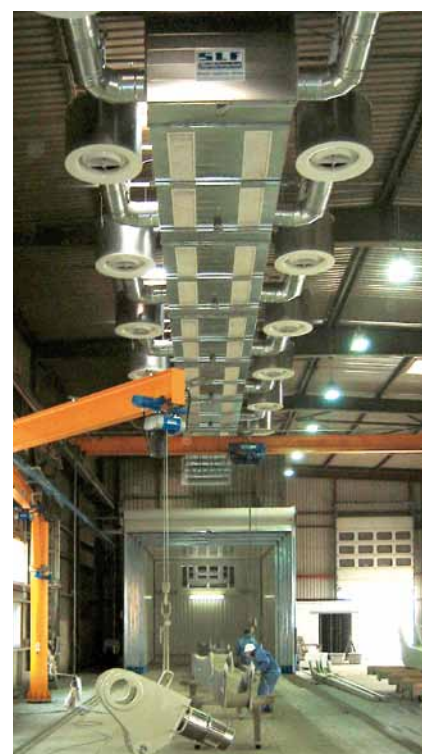
Sistema de pintura a céu aberto com bocas de longo alcance e secador telescópico.
