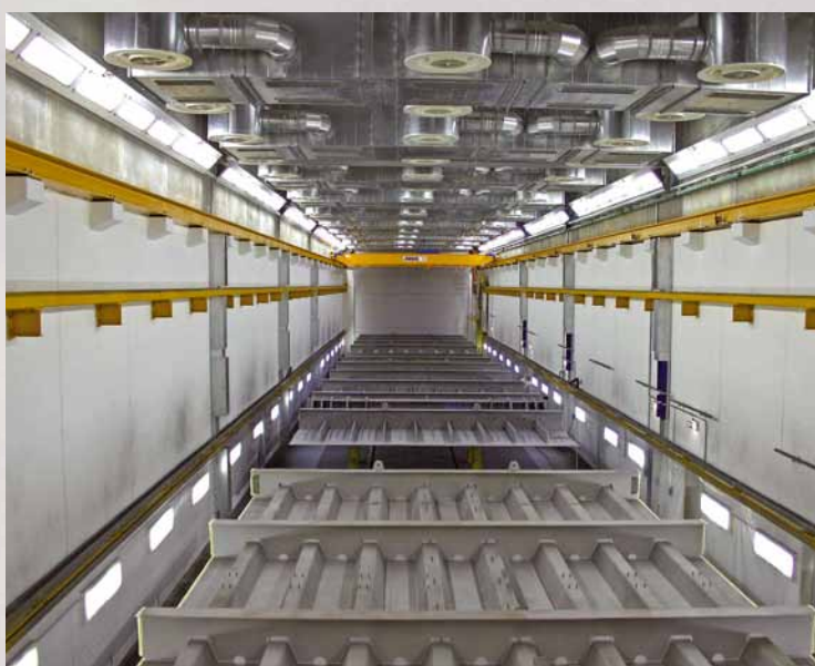
Cabine combinada de pintura e secagem com ventilação seccional por meio de bocas de longo alcance para elementos de pontes.
