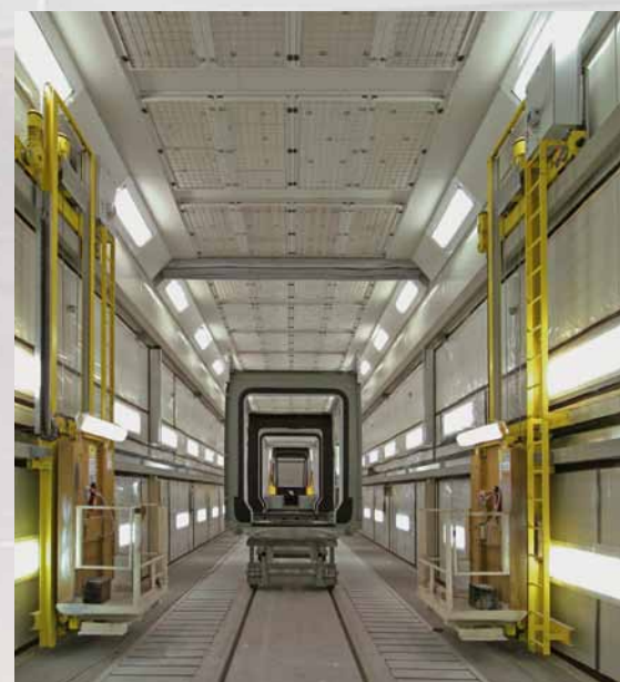
Cabine combinada de pintura e secagem com sistema de ventilação seccional para camionetas de passageiros.
