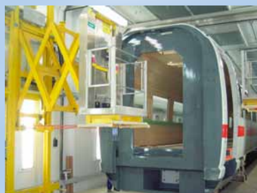
Corredor de pintura com plataforma elevatória lateral tipo tesoura.
