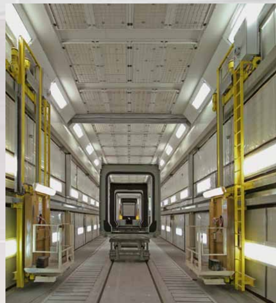
Cabina de pintura y secado combinada con sistema de ventilación seccional para coches de pasajeros.
