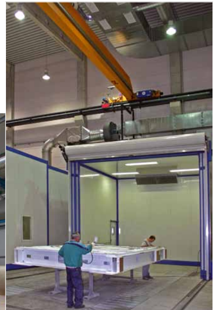
Sistema de pintura en espacio abierto con secador telescópico.
