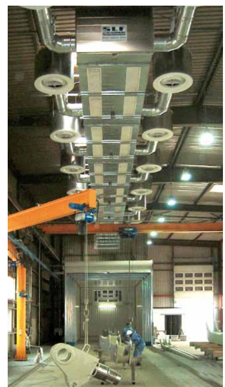
Sistema de pintura en espacio abierto con boquillas de largo alcance y secador telescópico.
