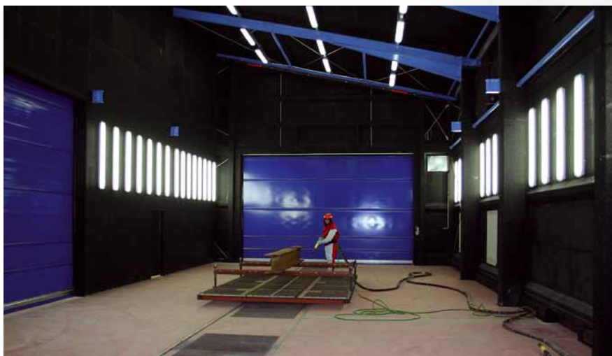
Habitáculo de granallado para componentes de la empresa Meyer Shipyard incl. recuperación parcial neumática.
