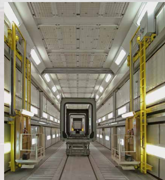
Kombinierte Spritz- und Trockenkabine für Reisezugwagen mit sektionaler Lüftung.
