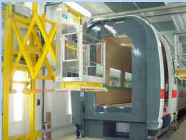
Lackierhalle mit seitenverfahrbarer Scherenhubbühne.
