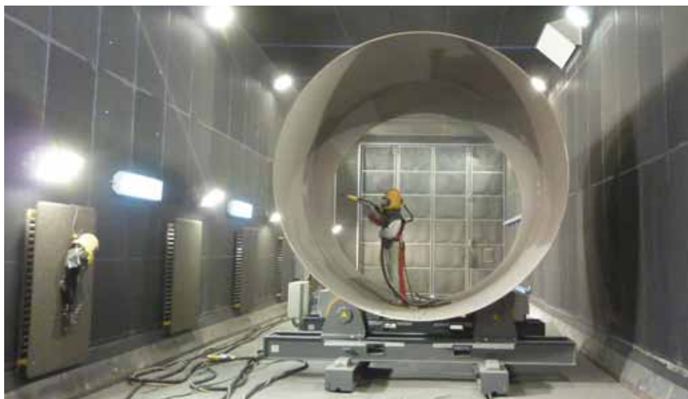
Kabina pro volné tryskání věžových segmentů
