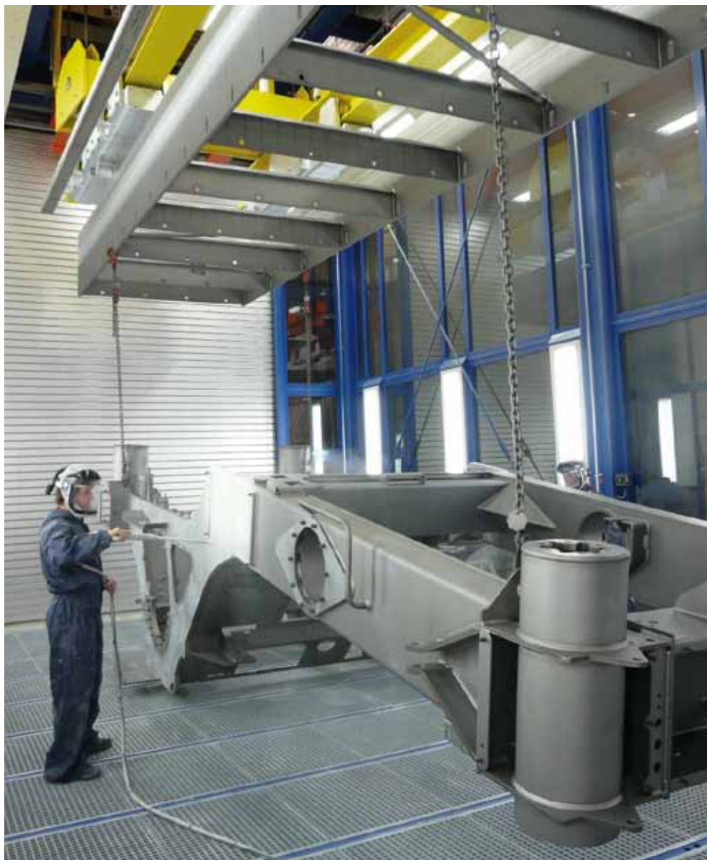
Práškový nástřik velkých konstrukčních dílů (Wirtgen GmbH)
