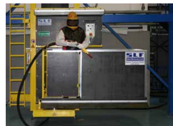
Po stranách vedená pracovní zdvižná plošina pro prostory pro volné tryskání.
