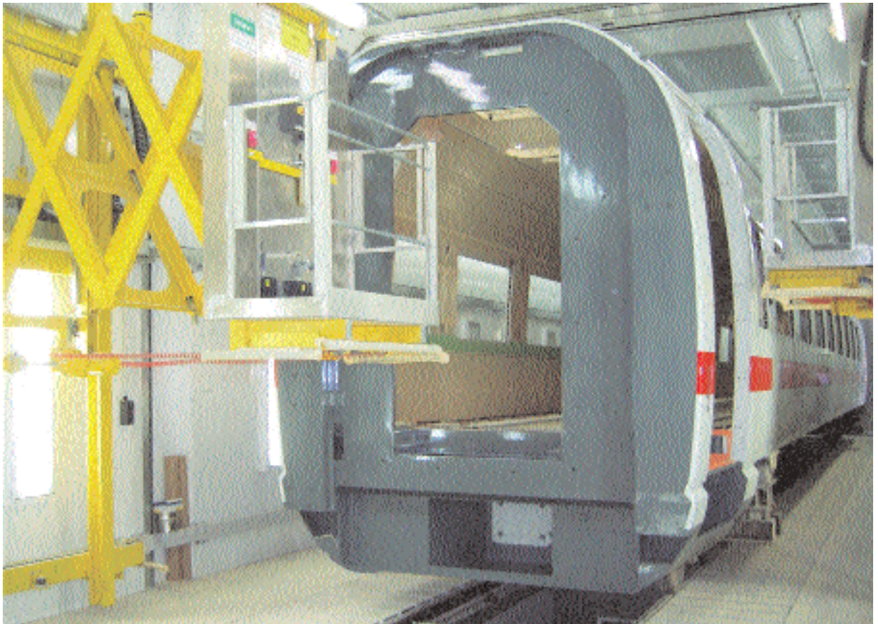
Lackierkabine mit automatischer Personen-Erkennung bei Siemens-Duewag in Krefeld
