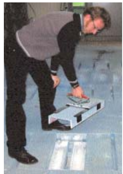
Gripper zur vereinfachten Entnahme der Prallabscheider
