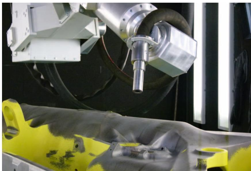
Komponenten aus der Luftfahrtindustrie mit schädlichen Lacken werden innen und außen automatisch entlackt
