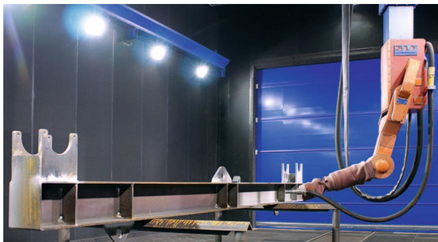
Auch Windkraftanlagen-Komponenten werden mit dem Strahlroboter automatisch gestrahlt
