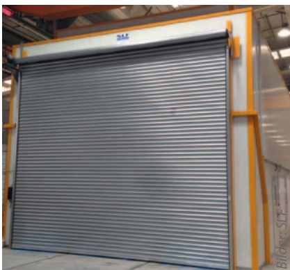
Die 18 m lange, kombinierte Spritz- und Trockenkabine bei Alho Systembau verfügt über zwei stirnseitig angebrachte Rolltore zur einfachen Beschickung mittels Schienentransport
