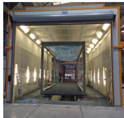
Schwer zugängliche Sektionen an der Unterseite des Werkstückes können bequem aus der Bodengrube heraus beschichtet werden
