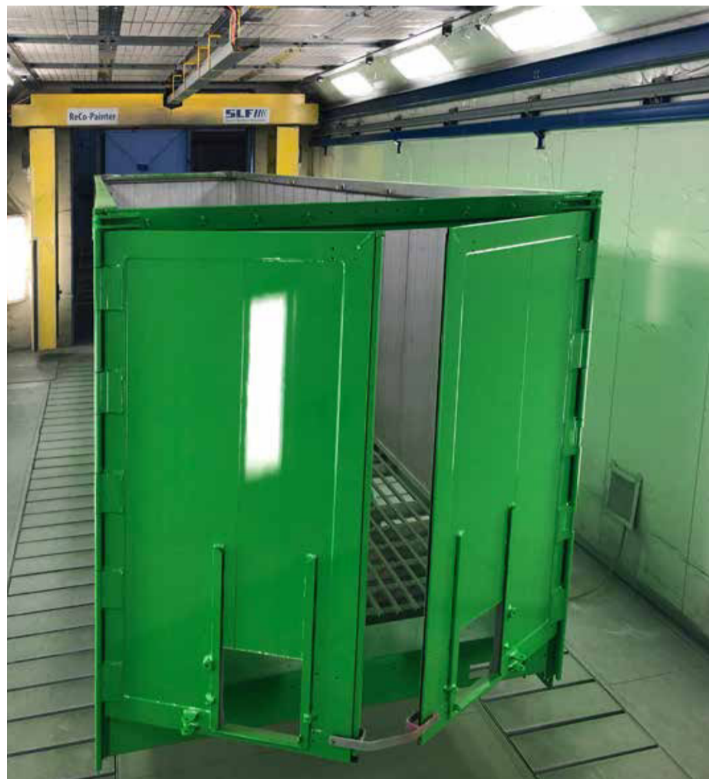
Bei Schwarzmüller wird der „ReCo-Painter“ für die Beschichtung von Schubboden-trailer eingesetzt. Der Hersteller beschichtet die 13 m langen und bis zu 4 m hohen Aluminiumwerkstücke automatisiert entsprechend der Kundenwünsche.
