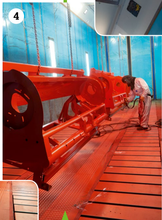
Die Lackierkabine ist in drei Sektionen unterteilt, die an den Prozess angepasst voneinander unabhängig belüftbar sind.
