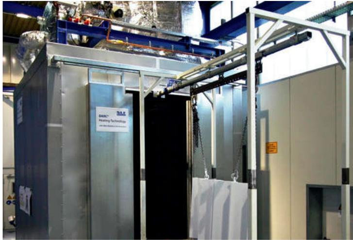
Die DARC-Technologie wird beim Hersteller kontinuierlich weiterentwickelt. Auf der Versuchsanlage im Bild konnte beim Pulverlackieren die Zahl der Prozessschritte erheblich reduziert werden. Quelle: SLF
