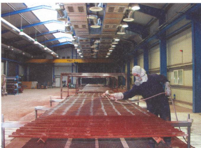
von 3 m x 3 m x 20 m in einem Freistrahllraum von innen und außen gestrahlt und auf zwei Freiflächenlackierplätzen beschichtet. Die Trocknung erfolgt in einer Abdunstzone in der Halle. Vorgesehen ist hier in der Zukunft ein Raum sparender Teleskoprockner für erhöhte Durchsatzleistungen.
