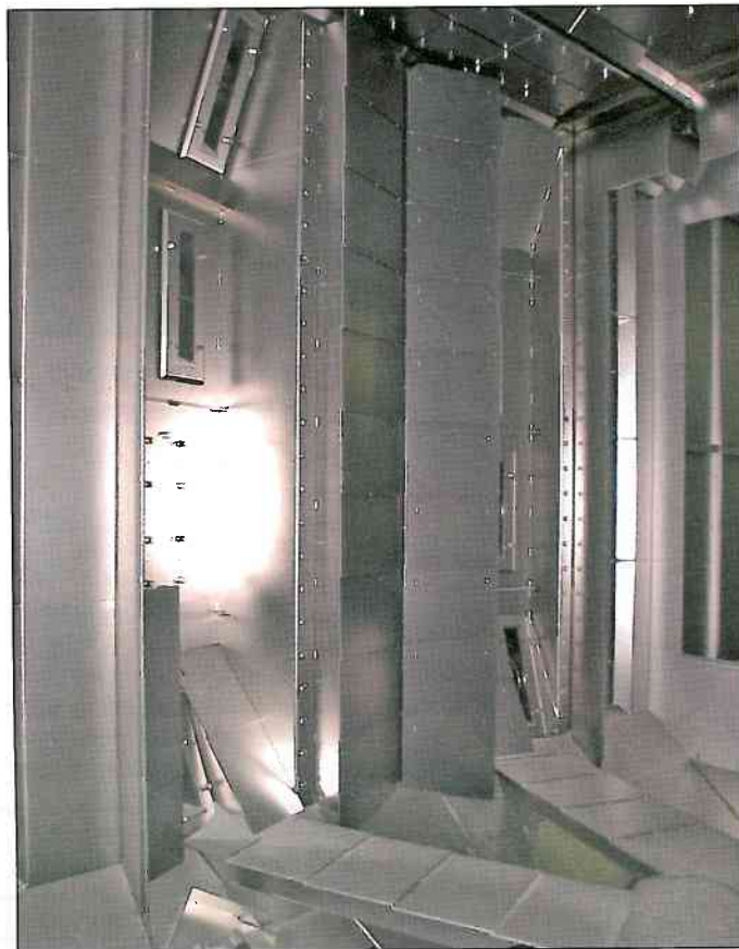
Der Strahlraum ist mit 16 Schleuderrädern ausgestattet, die in unterschiedlichen Höhen und Winkeln angeordnet sind.
