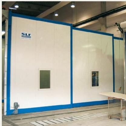
Ausgefahren: Die Reinigungskabine streckt sich von einer minimalen Länge von vier bis zu 12,5 Meter im komplett ausgefahrenen Zustand
