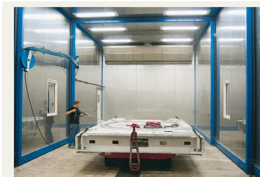
Unter Hochdruck: Die Reinigung der Bauteile erfolgt im geschlossenen Kreislauf
