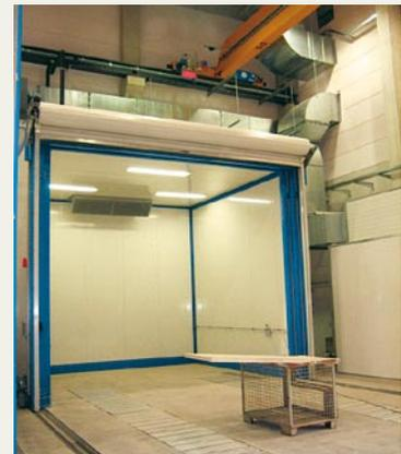
Eingefahren: Auch die Trockenkabine erleichtert mit der Teleskoptechnik das Teilehandling
