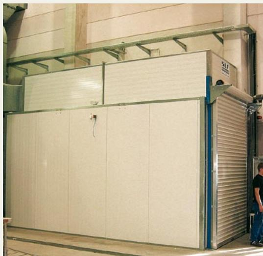
Kleinteile werden in einer kombinierten Spritz- und Trockenkabine lackiert
