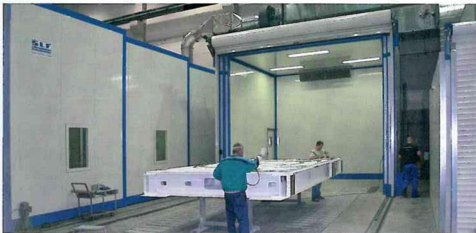
*Durch die Teleskop-Bauweise lässt sich die Reinigungskabine auf 4 m zusammen- und auf 12,5 m ausfahren* Bild: SLF
