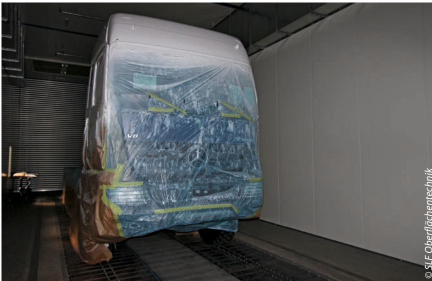
Bei bis zu 70 °C Umlufttemperatur werden die lackierten Bauteile im von der Lackierkabine befahrbaren Trockner getrocknet.
