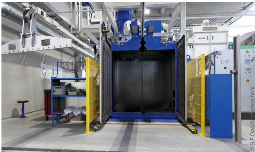
In der Hängebahn-Strahlanlage können Kleinteile automatisch gestrahlt werden
