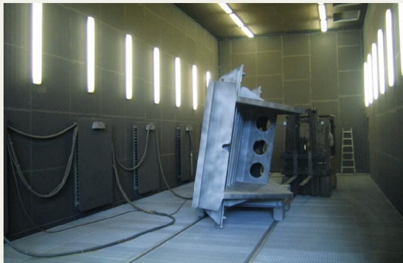
Im großzügig dimensionierten Freistrahraum werden die Teile von Rost und Zunder befreit
