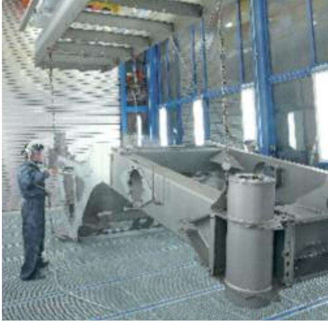
Pulverbeschichtung von Großbauteilen (Wirtgen GmbH)
