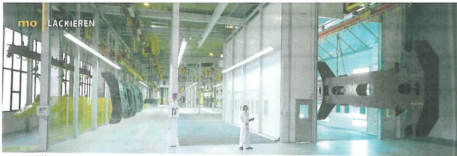
Liebherr setzt auf eine flurfreie Förderung von Großbauteilen mit entsprechender Lackierkabine – der hohe Aufwand garantiert gute Ergebnisse, erfordert aber auch gewisse Stückzahlen und Investitionskapital. Bild: Vollert
