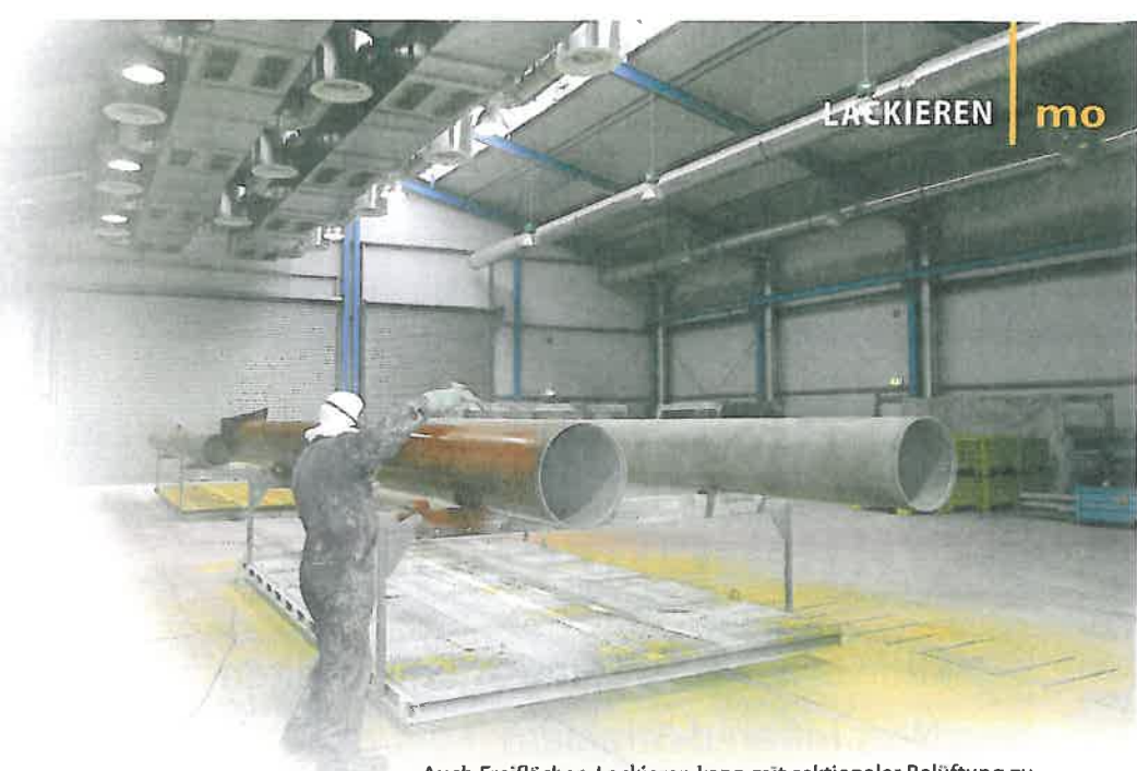
Auch Freiflächen-Lackieren kann mit sektionaler Belüftung zu einem guten Ergebnis führen. Darüber hinaus sind sie sehr flexibel und erlauben den Einsatz von Hallenkränen Bild: SLF
